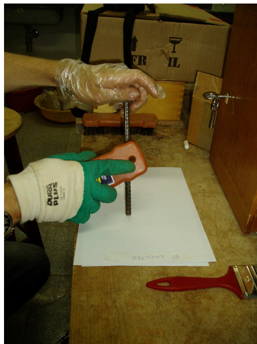
Figura 4.26 – Procedimento de limpeza das armaduras por meio de escova de aço.
