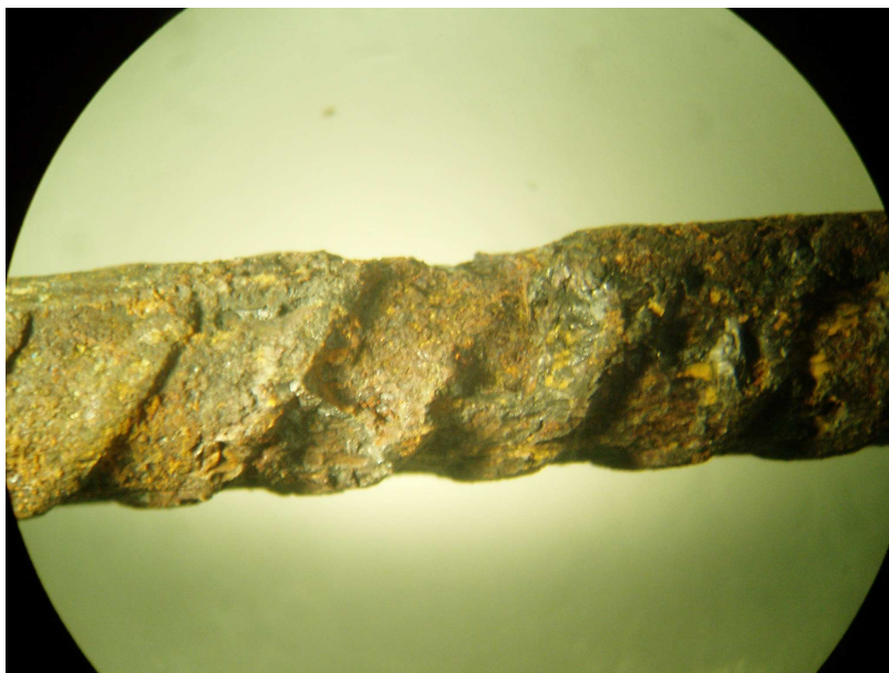
Figura 5.32 - Imagem estereoscópica da superfície da armadura após o procedimento de limpeza com hidrojateamento de alta pressão com 6000 psi apresentando pouca eficácia na remoção dos produtos de corrosão.
