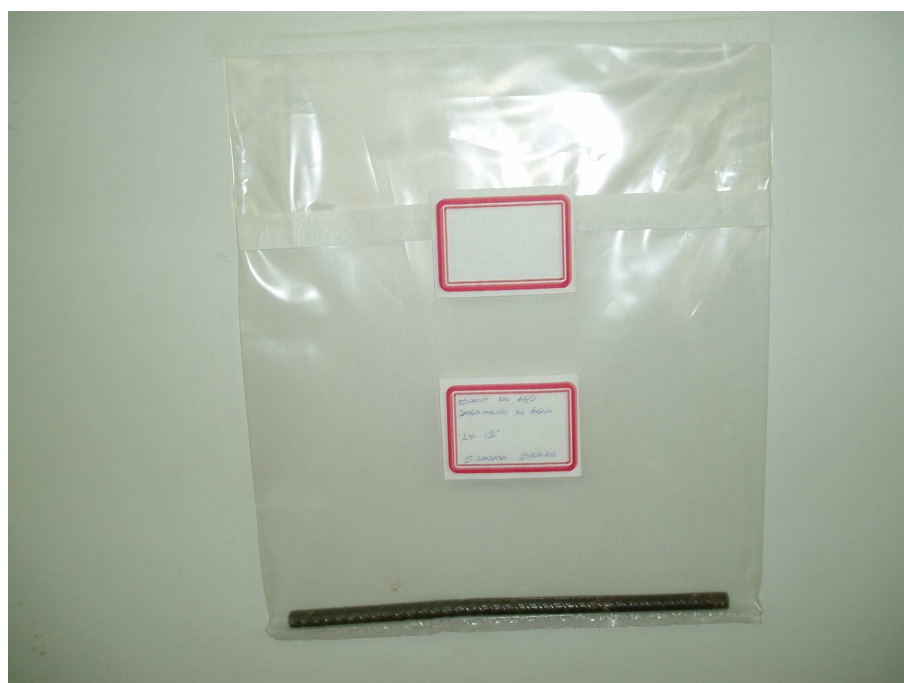
Figura 4.27 – Forma de armazenamento de todas as armaduras até momento da nova concretagem.
