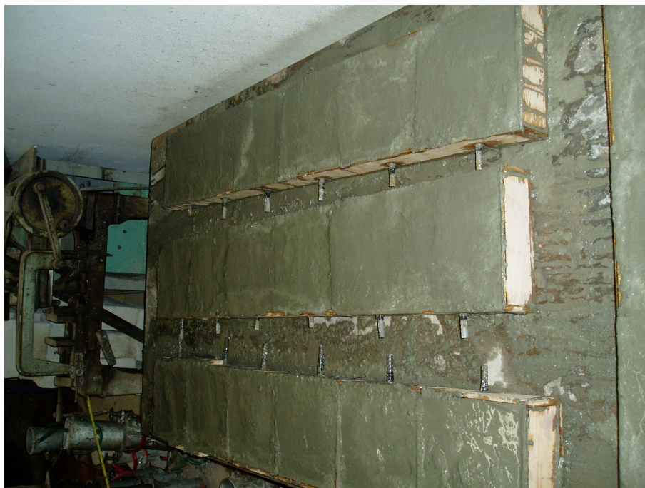
Figura 4.32 – Vibração dos corpos-de-prova em mesa vibratória no Laboratório de Materiais de Construção da EEC/UFG.
