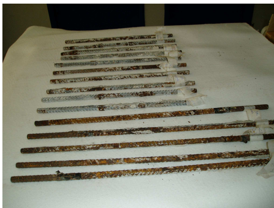
Figura 4.23 – Aspecto das armaduras corroídas logo após terem sido retiradas dos corpos de prova com 3% de cloretos.
