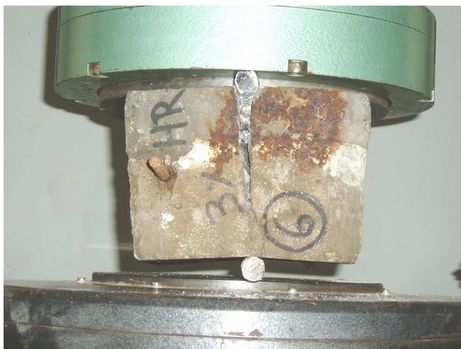
Figura 4.12 – Rompimento de corpo-de-prova por compressão axial.
