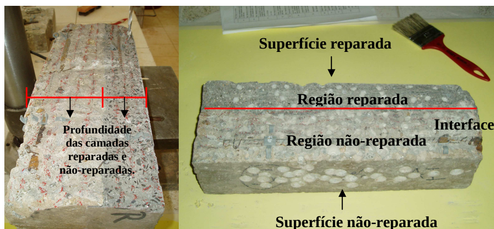
Figura 4.14 – Marcação das camadas de diferentes profundidades a serem perfuradas para extração das amostras de concreto.
