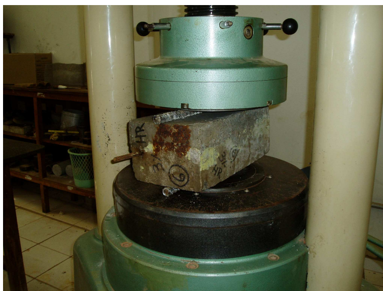
Figura 4.25 – Rompimento dos CP's por compressão axial para facilitar a remoção das armaduras.
