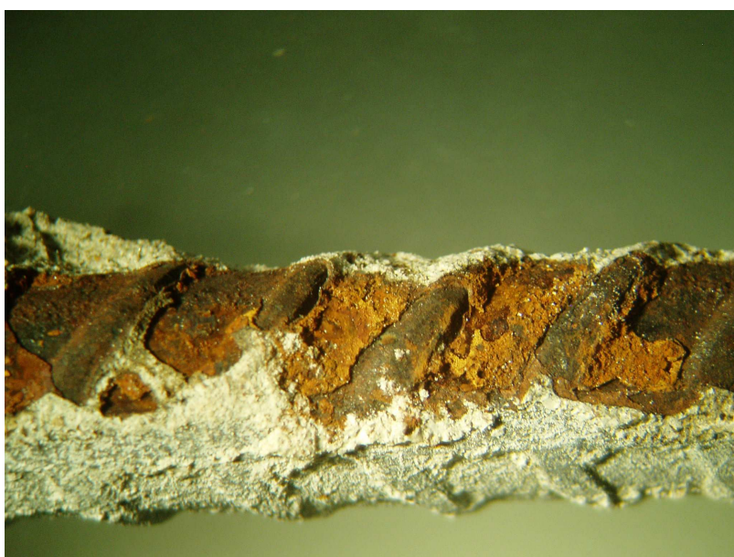
Figura 5.25 - Imagem estereoscópica da superfície da armadura sem procedimento de limpeza, apresentando avançado processo de corrosão.
