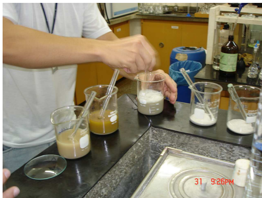
Figura 4.17 – Preparo das amostras, mistura das amostras no Becker com 75 ml de água deionizada e 25 ml de ácido nítrico.
