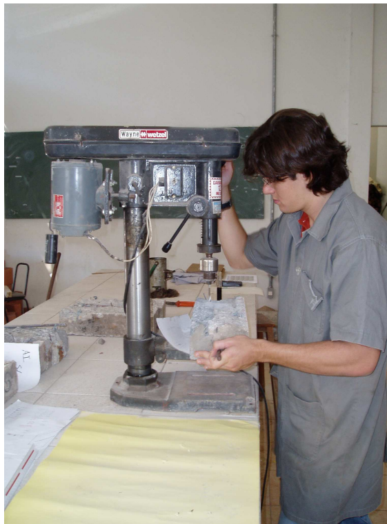
Figura 4.13 – Perfuração do corpo-de-prova por meio de uma furadeira de bancada para a obtenção das amostras pulverizadas de concreto.
