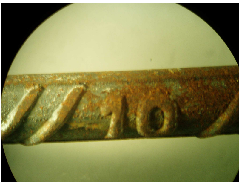
Figura 5.31 – Imagem estereoscópica da superfície da armadura após o procedimento de limpeza com hidrojateamento de alta pressão com 6000 psi.
