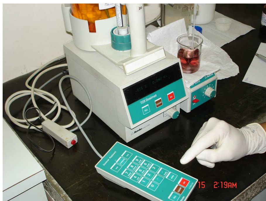
Figura 4.22 – Adição do Nitrato de mercúrio até obter a coloração azul-violeta.
