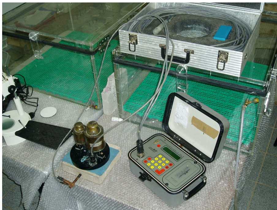
Figura 4.34 – Monitoramento dos corpos-de-prova por meio do GECOR6, avaliando os sistemas de limpeza das armaduras.
