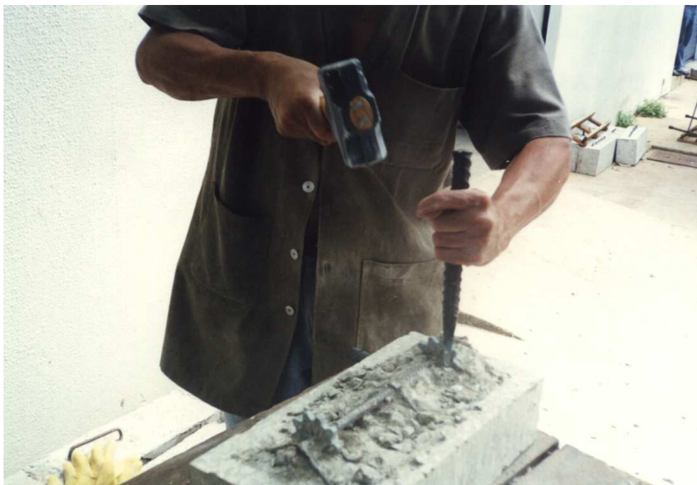
Figura 4.5 – Corte e escarificação dos corpos-de-prova até exposição total da armadura principal (TINOCO, 2001).
