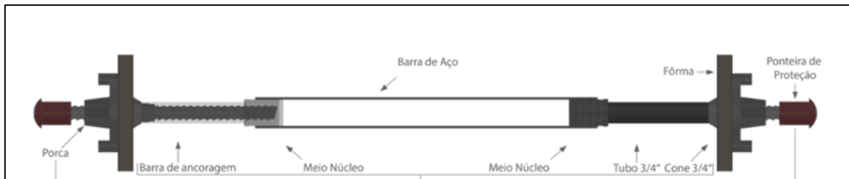
Figura 3.2 – Detalhe esquemático do espaçador com núcleo perdido.
