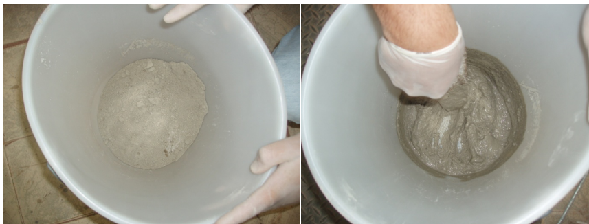
Figura 2.6 – Mistura dos materiais secos e posterior adição de água.
