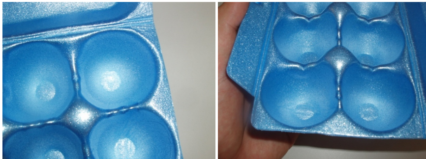
Figura 2.2 – Detalhe dos sulcos internos que servirão de fôrma das pastilhas.
