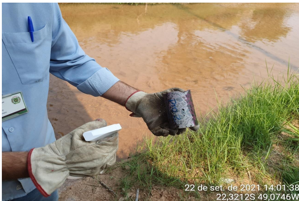
Figura 3.15: Aspersão de solução contendo fenolftaleína em testemunho (SMO, 2022).
