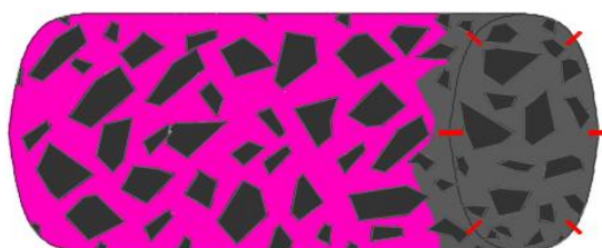
Figura 3.12: Representação dos pontos, destacados em vermelho, de obtenção da frente de carbonatação, obtidos para cada testemunho.
