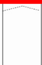
Figura A.7 – Tipo G – Similar ao tipo F com fraturas próximas ao topo
