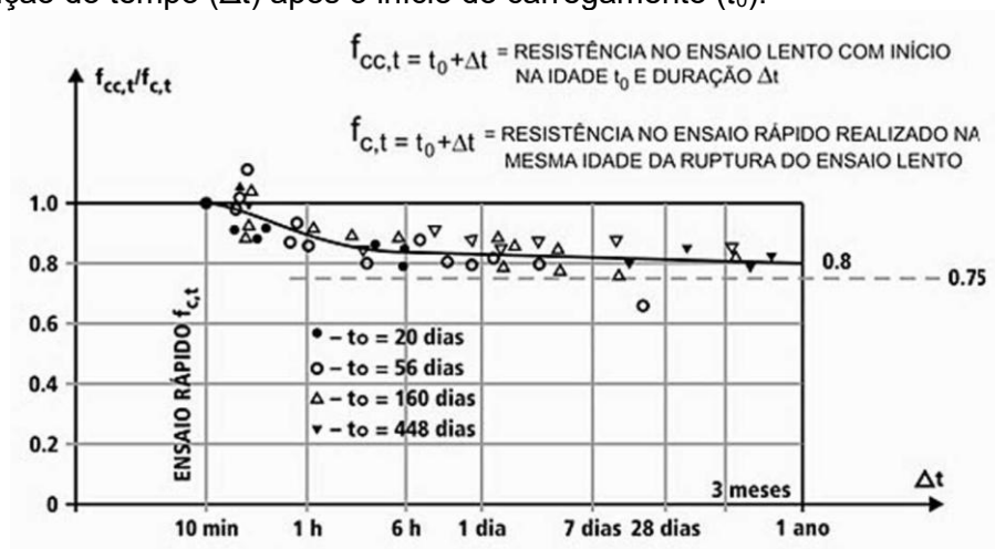
Figura 5.6 – Relação entre resistências obtidas em ensaios lentos e rápidos ( f_{cc,t}/f_{c,t} ) em função do tempo ( \Delta t ) após o início do carregamento ( t_0 ).
