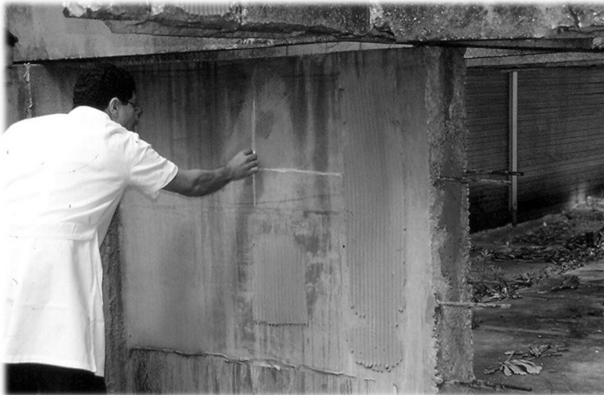
Pacômetro → Princípio: Eletromagnetismo
