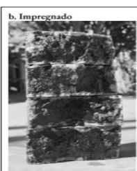
Figura 7. Comparação da aferição da frente de carbonatação com fenolftaleína, no traço de relação água/cimento 0,45, ao final dos 360 dias de experimento
