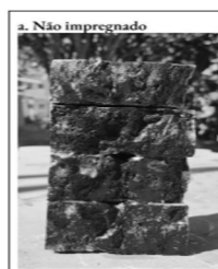
Figura 8. Comparação da aferição da frente de carbonatação com fenolftaleína, no traço de relação água/cimento 0,55, ao final dos 360 dias de experimento
