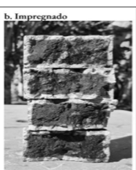
Figura 9. Comparação da aferição da frente de carbonatação com fenolftaleína, no traço de relação água/cimento 0,60, ao final dos
