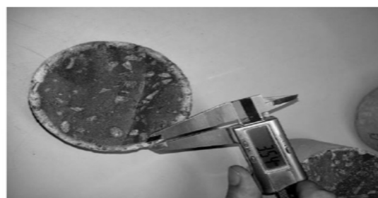
Figura 11. Medição da profundidade de carbonatação para massa específica de 1700 kg/m³
