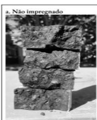
Figura 10. Comparação da aferição da frente de carbonatação com fenolftaleína, no traço de relação água/cimento 0,65, ao final dos
