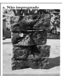
Figura 9. Comparação da aferição da frente de carbonatação com fenolftaleína, no traço de relação água/cimento 0,60, ao final dos
