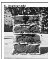
Figura 8. Comparação da aferição da frente de carbonatação com fenolftaleína, no traço de relação água/cimento 0,55, ao final dos 360 dias de experimento
