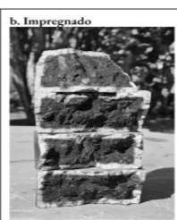
Figura 10. Comparação da aferição da frente de carbonatação com fenolftaleína, no traço de relação água/cimento 0,65, ao final dos
