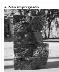
Figura 7. Comparação da aferição da frente de carbonatação com fenolftaleína, no traço de relação água/cimento 0,45, ao final dos 360 dias de experimento
