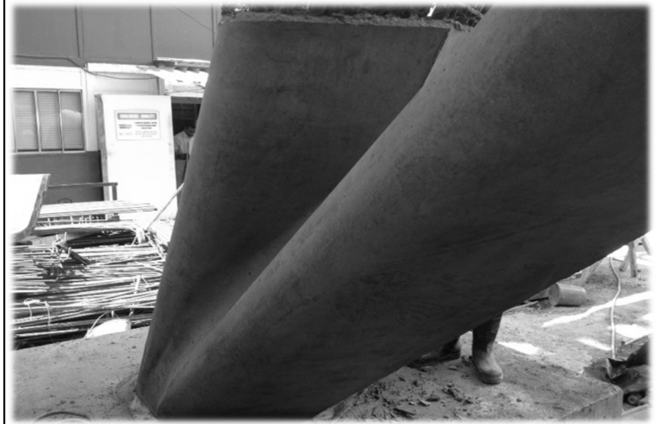
Columna prototipo: concreto SCC (auto-compactable, 50MPa, sin vibrado)
