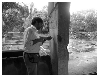
Medição da dureza superficial através de Esclerometria
