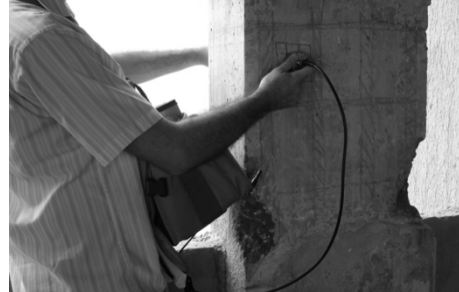
Medida de propagação de ondas ultrassônicas e do potencial de corrosão
