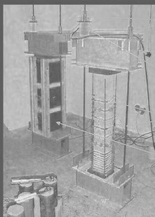
Reforço do pilar de seção quadrada
