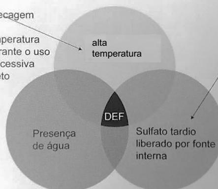
Agregado contaminado por gipsita, ou liberação de sulfato pelo C-S-H
