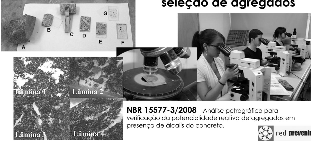
**NBR 15577-3/2008** – Análise petrográfica para verificação da potencialidade reativa de agregados em presença de álcalis do concreto.
