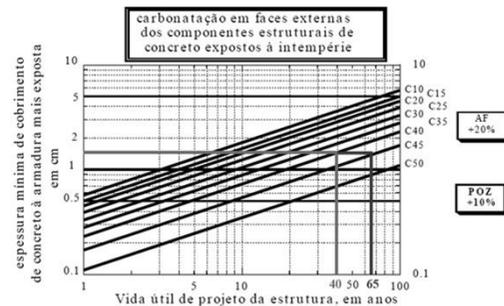
Segundo este modelo, ao utilizar o concreto B, obtém-se um incremento de vida útil de projeto, VUP, de cerca de 63% em relação à VUP do concreto de A.
