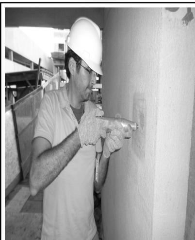
VERIFICAR A HOMOGENEIDADE ATRAVÉS DA DUREZA SUPERFICIAL DO CONCRETO
