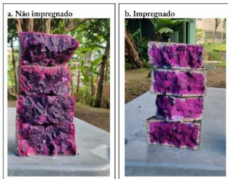
Figura 48 - Área de frente de carbonatação no concreto de traço 0.65 no período de T180.
