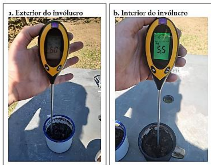
Figura 27 - Diferença de pH nos recipientes dispostos fora (a) e dentro (b) do invólucro impregnado por fuligem no período de 90 dias.
