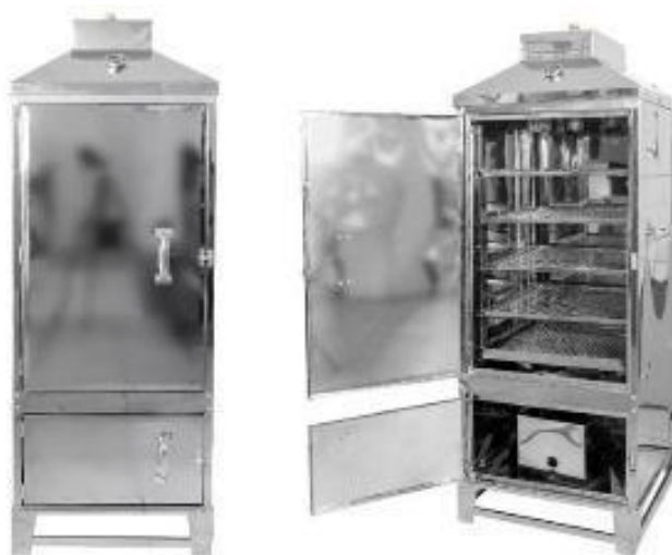
Figura 16 - Defumador utilizado como invólucro para queima dos corpos de prova.
