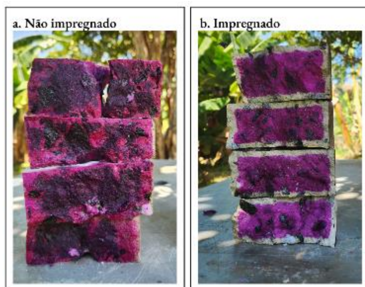
Figura 44 - Área de frente de carbonatação no concreto de traço 0.60 no período de T270.
