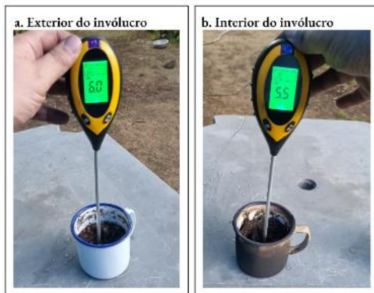
Figura 28 - Diferença de pH nos recipientes dispostos fora (a) e dentro (b) do invólucro impregnado por fuligem no período de 180 dias.
