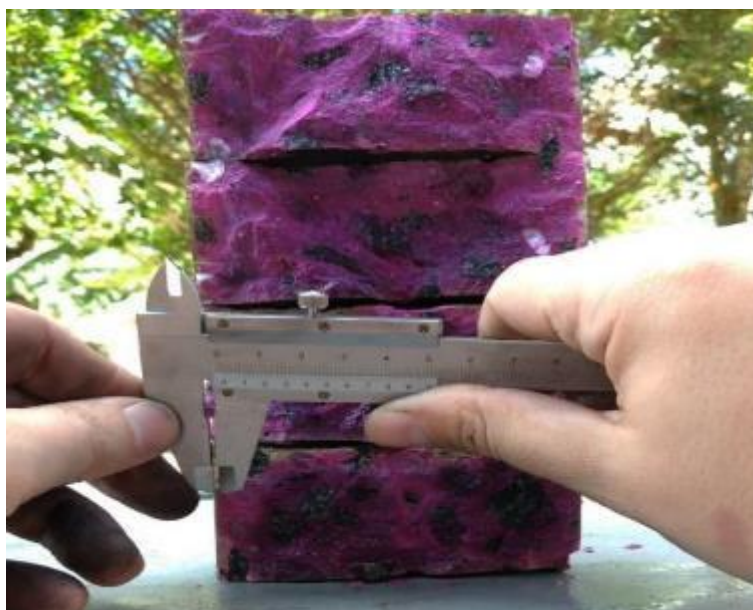
Figura 23 – Medição da área carbonatada com paquímetro.
