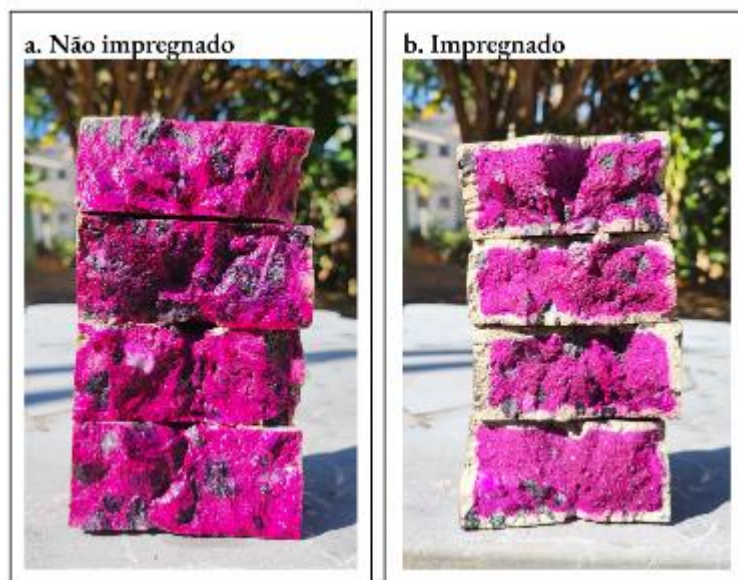
Figura 40 - Área de frente de carbonatação no concreto de traço 0.55 no período de T360.
