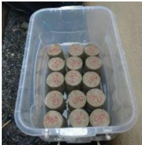
Figura 9 - Processo de cura do concreto.
