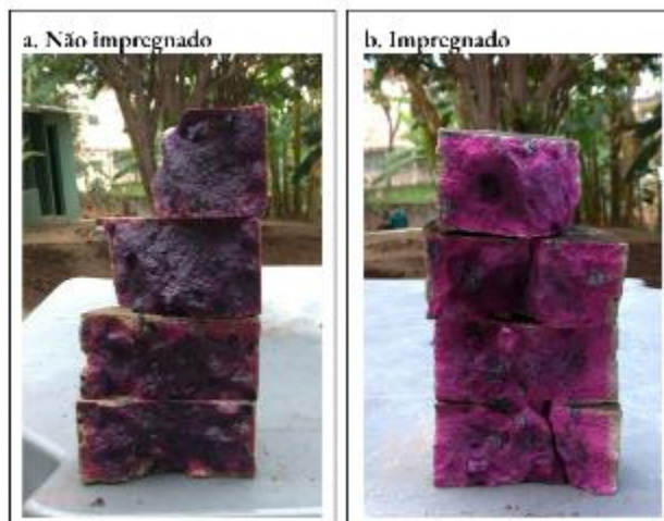
Figura 46 - Área de frente de carbonatação no concreto de traço 0.65 no período de T0.
