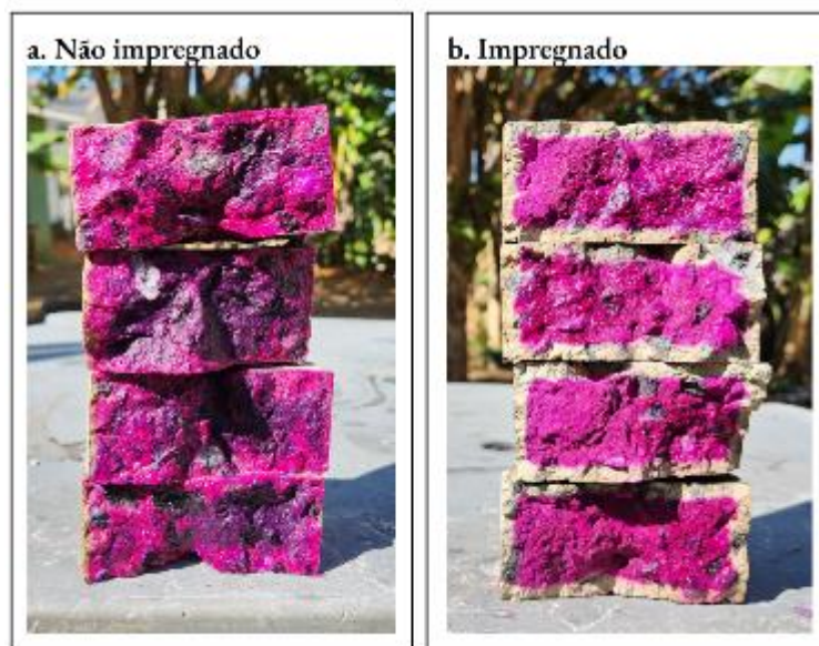
Figura 45 - Área de frente de carbonatação no concreto de traço 0.60 no período de T360.
