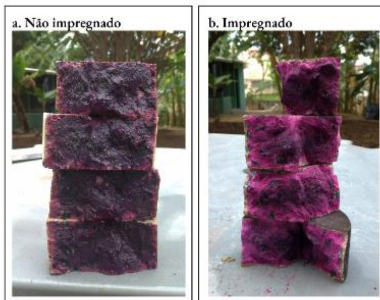
Figura 41 - Área de frente de carbonatação no concreto de traço 0.60 no período de T0.
