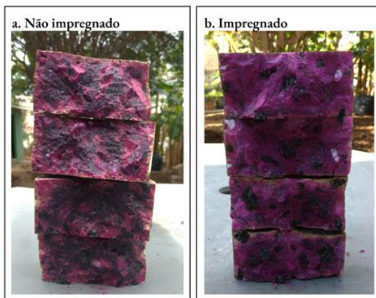
Figura 31 - Área de frente de carbonatação no concreto de traço 0.45 no período de T0.
