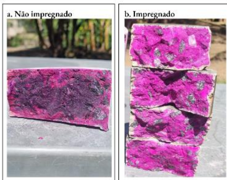
Figura 32 - Área de frente de carbonatação no concreto de traço 0.45 no período de T90.
