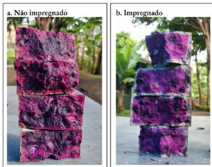
Figura 43 - Área de frente de carbonatação no concreto de traço 0.60 no período de T180.
