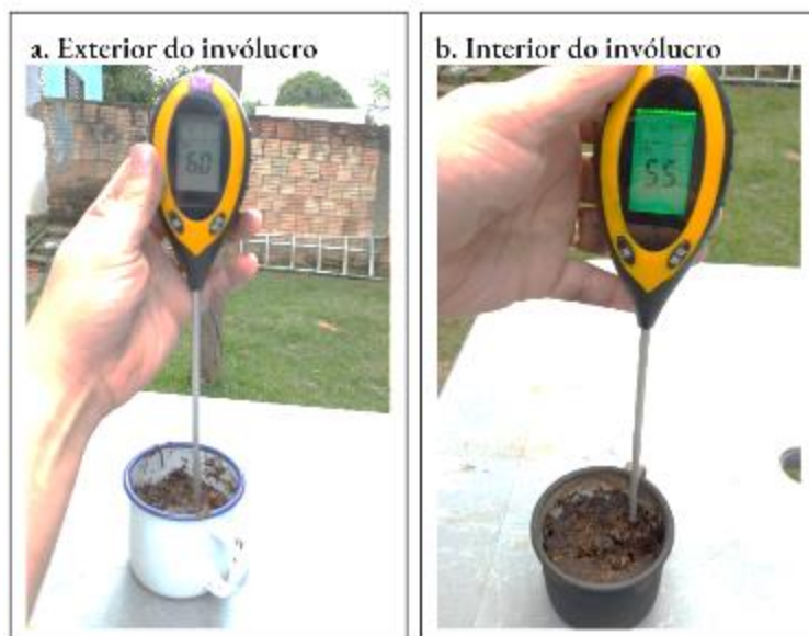
Figura 26 - Diferença de pH nos recipientes dispostos fora (a) e dentro (b) do invólucro impregnado por fuligem no período de T0.
