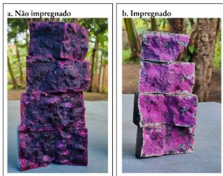
Figura 33 - Área de frente de carbonatação no concreto de traço 0.45 no período de T180
