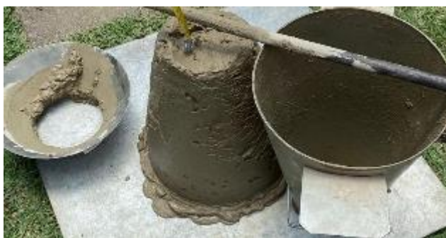
Figura 8 - Teste de teste abatimento de tronco de cone.
