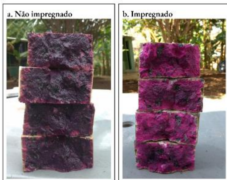
Figura 36 - Área de frente de carbonatação no concreto de traço 0.55 no período de T0.
