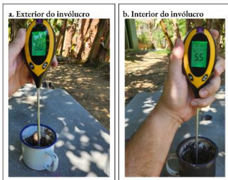
Figura 29 - Diferença de pH nos recipientes dispostos fora (a) e dentro (b) do invólucro impregnado por fuligem no período de 270 dias.
