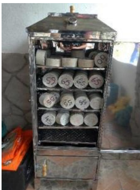
Figura 19 - Corpos de prova dispostos no interior do invólucro, sendo que cada traço foi disposto em um nível do invólucro.
