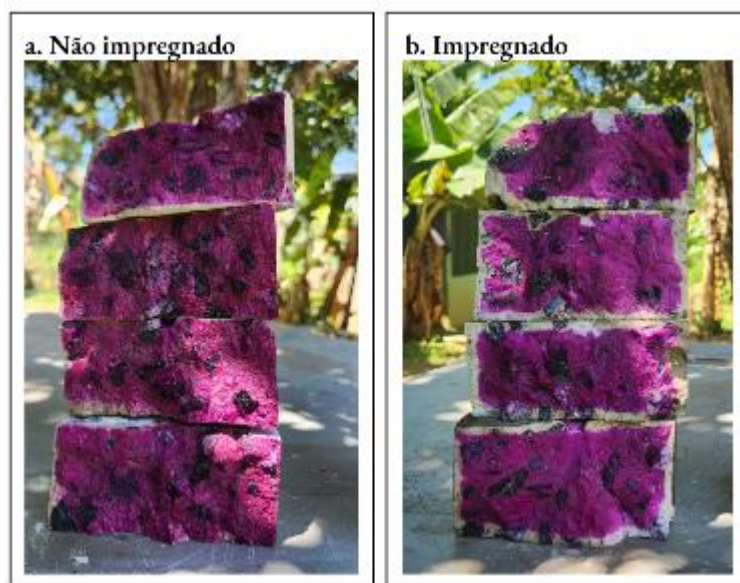
Figura 39 - Área de frente de carbonatação no concreto de traço 0.55 no período de T270.
