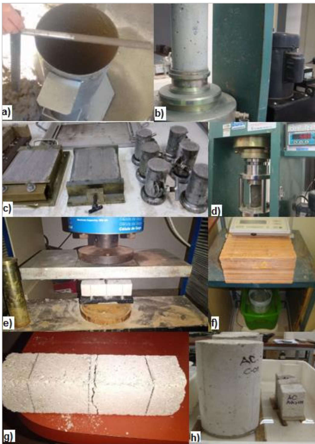
Figura 73 – Fotografias dos ensaios de caracterização dos materiais: a) consistência do concreto por Slump Test; b) resistência à compressão concreto); c) CPs de argamassa para ensaios de resistência mecânica; d) resistência à compressão em CPs de argamassa; e) resistência à tração na flexão de CPs de argamassa; f) pesagem hidrostática de CPs; g) CP de argamassa após rompimento de flexão; h) ensaio de absorção por capilaridade em CPs de concreto e argamassa.
