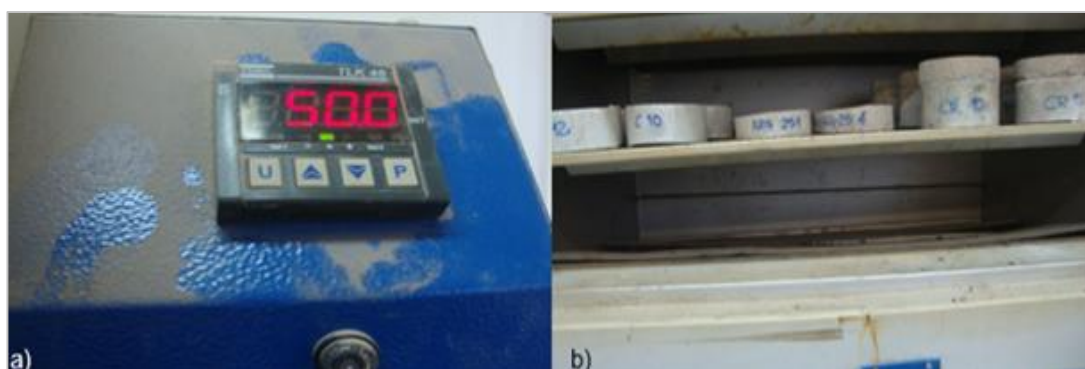
Figura 78 – Fotografias da obtenção do GS alvo de 80% e 60% para cada tipo de CPs: a) estufa com controle de temperatura 50°C; b) interior da estufa com os CPs em secagem parcial.
