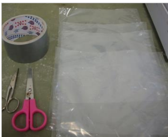
Figura 79 – Fotografia do material para ensacamento CPs; sacos plásticos e fita de alta adesão. Fonte: Autor.
