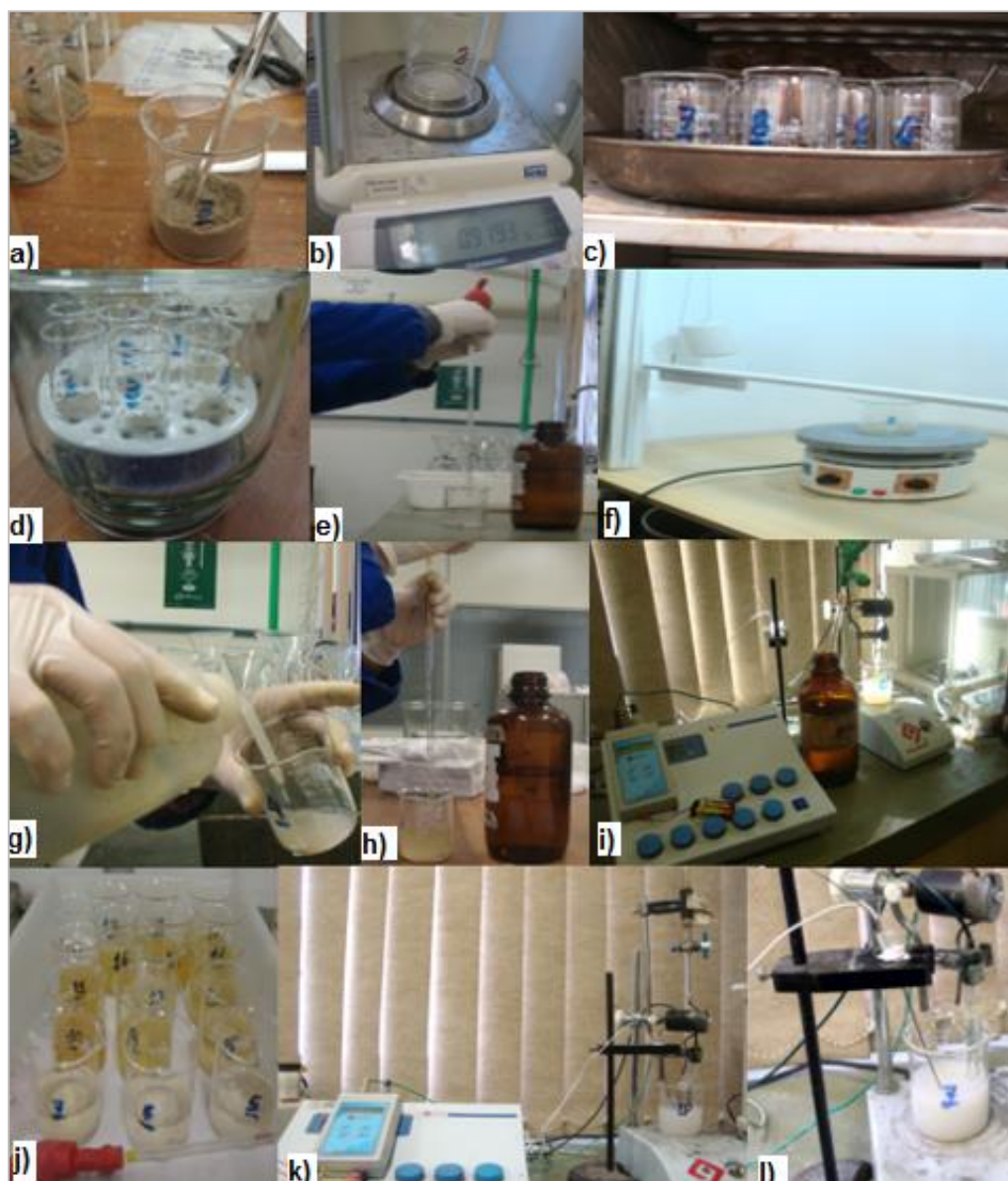
Figura 93 – Fotografias dos procedimentos para obtenção dos perfis de cloreto: a); homogeneização das amostras; b) pesagem em balança analítica; c) secagem em estufa; d) esfriamento em dessecador; e) aplicação de solução de ácido nítrico; f) fervura; g) lavagem paredes recipiente pós fervura; h) aplicação de hidróxido de cálcio; i) correção de pH; j) amostras prontas para a potenciometria; k); l) potenciometria.
