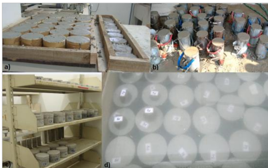
Figura 72 – Fotografia da confecção e cura dos CPs: a) CPs de argamassa e concreto revestido; b) confecção dos CPs de concreto (10x20cm); c) CPs em câmara úmida; d) CPs de concreto em cura por imersão de 21 dias.
