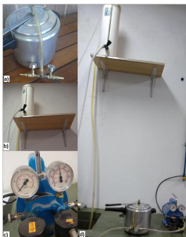
Figura 76 –Sistema de saturação a vácuo: a) recipiente com fechamento hermético e válvulas para controle de fluxo da água e do vácuo; b) depósito graduado para água destilada; c) bomba de vácuo; d) sistema completo.
