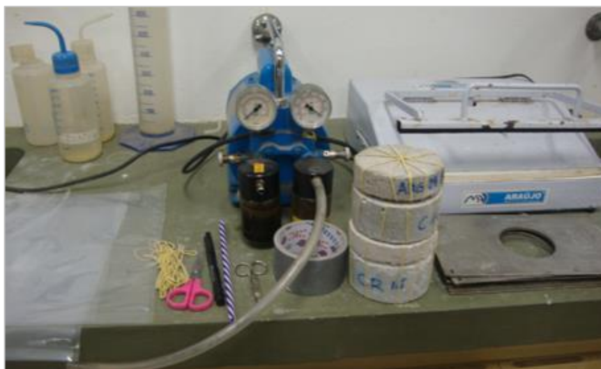
Figura 80 – Fotografias dos materiais e equipamentos utilizados para ensacamento dos conjuntos de CPs.
