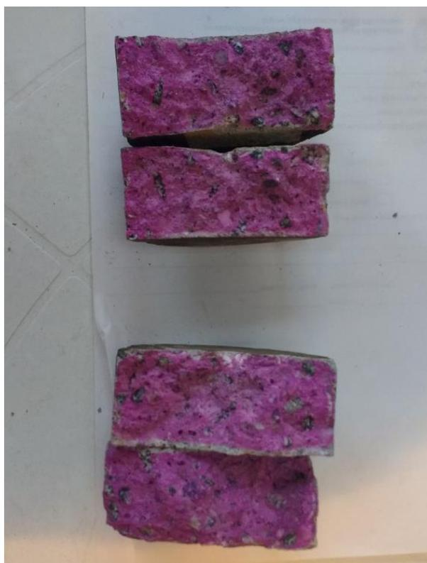
Figura 27 – Corpos de Prova impregnados fuligem à 30 dias
