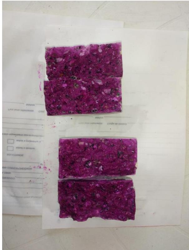
Figura 25 – Corpos de Prova sem fuligem à 30 dias
