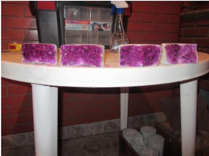
Figura 32 – Corpos de Prova sem fuligem à 90 dias
