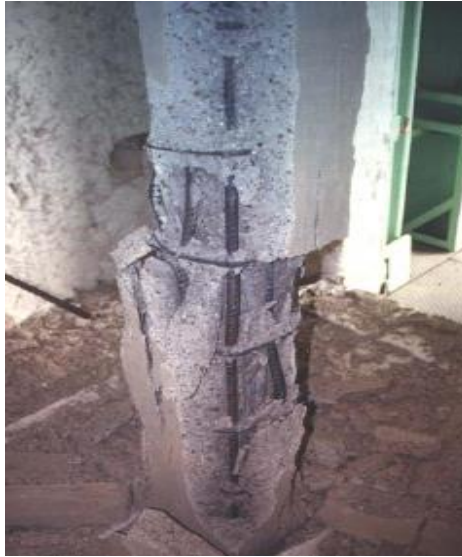
Figura 10. Exemplo de spalling explosivo ocorrido em pilar de concreto de alta resistência f_{ck} = 83 \text{ MPa} (Kodur et al., 2005).
