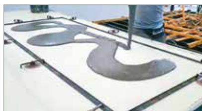
Figura 5 Aplicação do UHPC para a produção das placas
