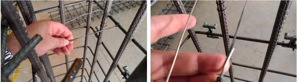
**Figura 15** – Detalhe da ponta do termopar instalado no eixo da amostra (fixado junto à malha de arame recozido).
