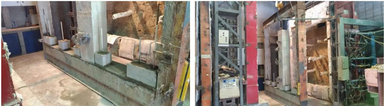
**Figura 50** – Detalhe da construção da alvenaria de fechamento do forno, especialmente projetada com blocos inteiros e meio blocos de concreto estrutural, vazados, e da locação de uma amostra como gabarito.
