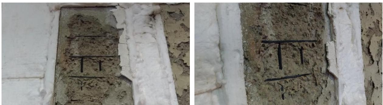
**Figura 74** – Detalhe do deslocamento de grandes proporções com exposição da armadura, na amostra revestida com gesso liso lento popular de mercado.
