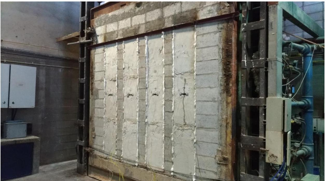
**Figura 70** – Detalhe de todas as amostras já locadas na alvenaria de fechamento para o segundo evento de ensaio.
