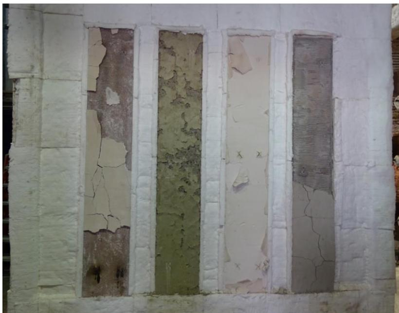
**Figura 55** – Detalhe da condição dos elementos e revestimentos, após abertura do forno (evento 1).
