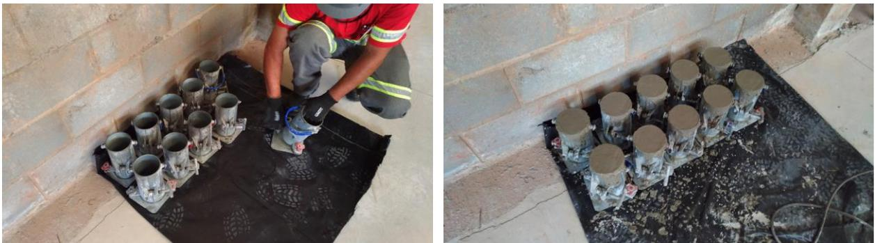
**Figura 27** – Detalhe da preparação e moldagem de 10 corpos de prova com 10cm x 20cm.
