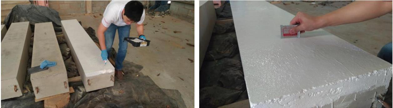
**Figura 36** – Detalhe da última demão de tinta intumescente e conferência da espessura (540 micrometros) com uso de medidor de espessura de camada de tinta. A tinta foi aplicada em três demãos.
