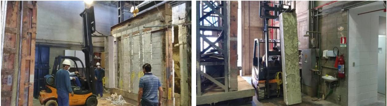
**Figura 65** – Remoção cuidadosa dos elementos do primeiro evento de ensaio.
