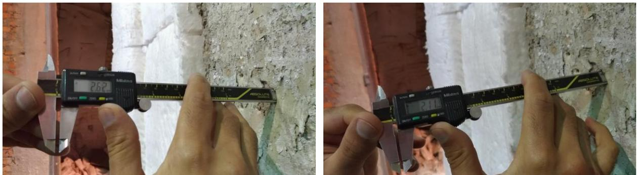
**Figura 78** – Detalhe do deslocamento no restante do elemento revestido com gesso liso lento de mercado (da ordem de 2 mm a 3 mm).
