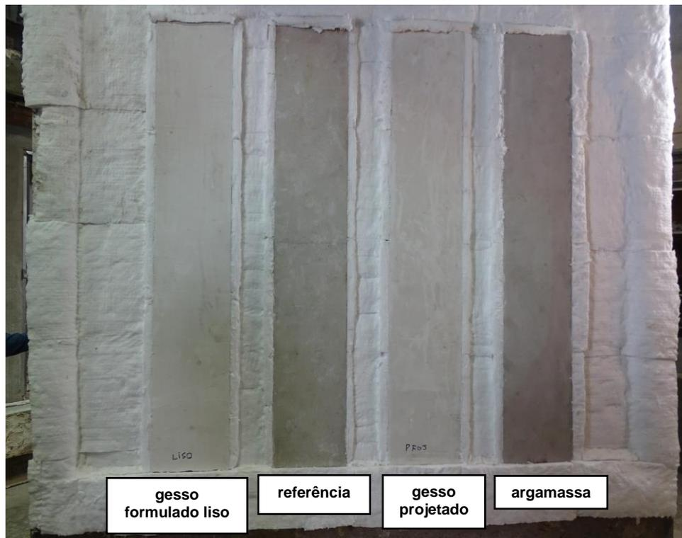
**Figura 53** – Detalhe da face que será exposta ao fogo antes do fechamento do quadro no forno com indicação dos revestimentos (evento 1).
