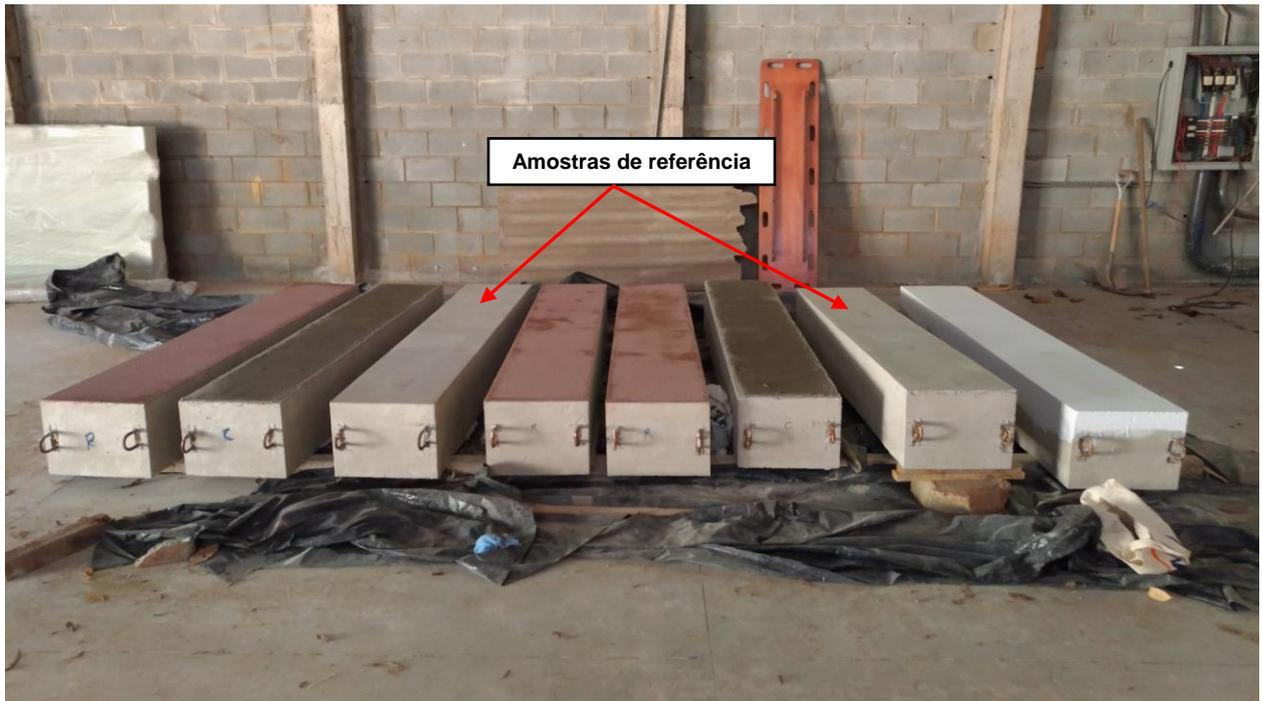
**Figura 39** – Detalhe de todas as amostras com as bases preparadas (exceto as duas amostras de referência) para aplicação dos revestimentos.
