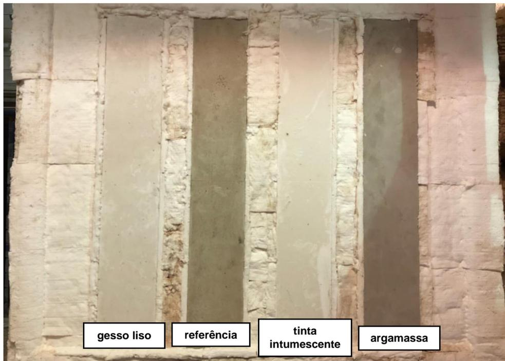
**Figura 71** – Detalhe da face que será exposta ao fogo antes do fechamento do quadro no forno com indicação dos revestimentos (evento 2).
