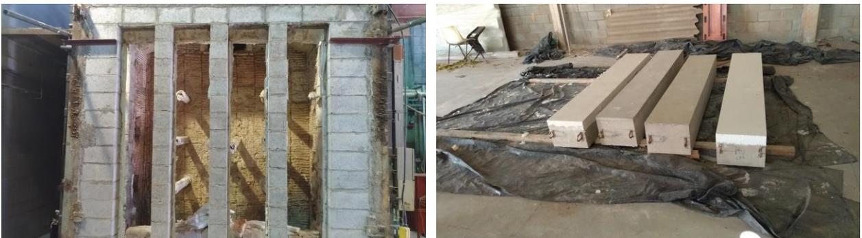
**Figura 67** – Detalhe da alvenaria preservada para o segundo evento de ensaio e das amostras do evento 2, ainda antes do transporte ao Laboratório de Segurança ao Fogo e Explosões.
