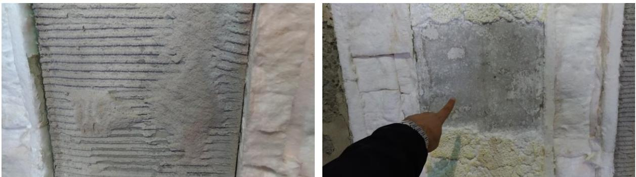
**Figura 76** – Detalhe do chapisco íntegro na amostra com revestimento de argamassa e do elemento de concreto intacto (e também íntegro) após raspagem da tinta intumescente.
