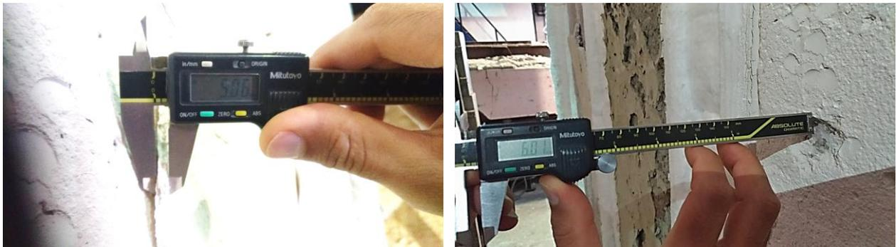
**Figura 58** – Detalhe da aferição, com uso de paquímetro digital, da parte de gesso projetado delaminada (da ordem de 5 mm), e da parte remanescente ainda aderida na amostra (da ordem de 6 mm).
