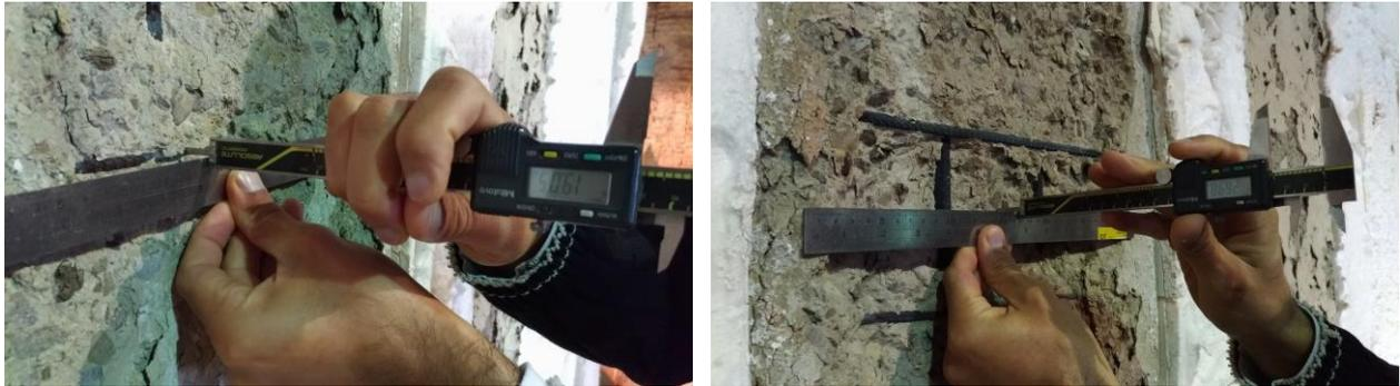
**Figura 77** – Detalhe da aferição da profundidade de deslocamento/*spalling* na amostra revestida com gesso liso lento de mercado (entre 19 mm e 27 mm).
