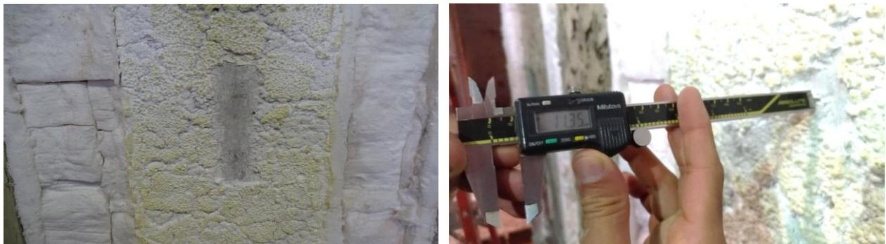
**Figura 80** – Detalhe da raspagem da tinta intumescente e da aferição de sua expansibilidade após o ensaio de simulação de incêndio (da ordem de 120 mm).
