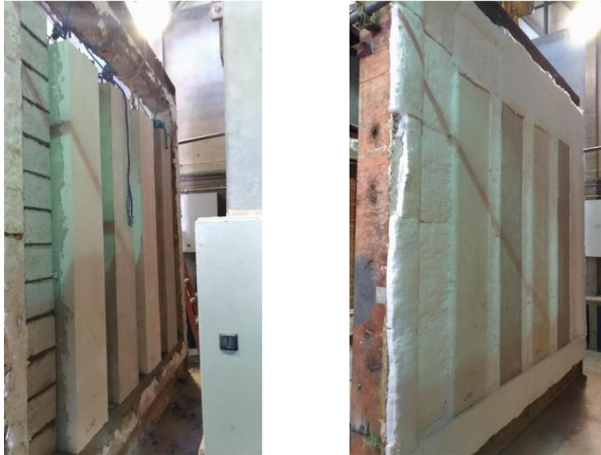
**Figura 52** – Detalhe da parte interna da alvenaria, antes (à esquerda) e depois (à direita) da proteção com manta de fibra cerâmica tipo Durablanket com  $96 \text{ kg/m}^3$  e espessura de  $50,8 \text{ mm}$ .
