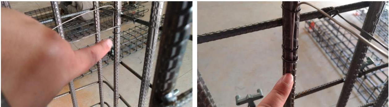
**Figura 16** – Detalhe da ponta do termopar instalado na armadura longitudinal (região do cobrimento na face que será exposta ao fogo).
