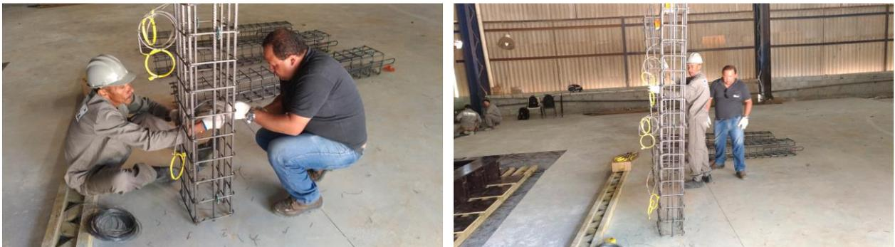
**Figura 17** – Detalhe da instalação dos termopares na cota mais baixa e de todos os termopares já instalados.
