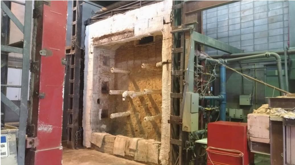
**Figura 47** – Detalhe do forno vertical do Laboratório de Segurança ao Fogo e Explosões do IPT.
