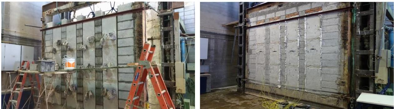
**Figura 51** – Detalhe da alvenaria sendo construída (à esquerda) e já finalizada (à direita), com fechamento em tijolos na parte superior de cada elementos de concreto.
