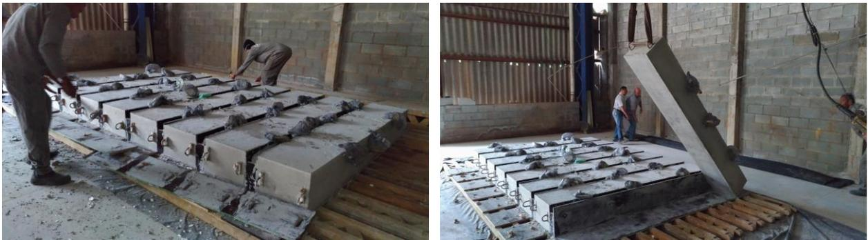
**Figura 30** – Detalhe da desfôrma e içamento dos elementos.
