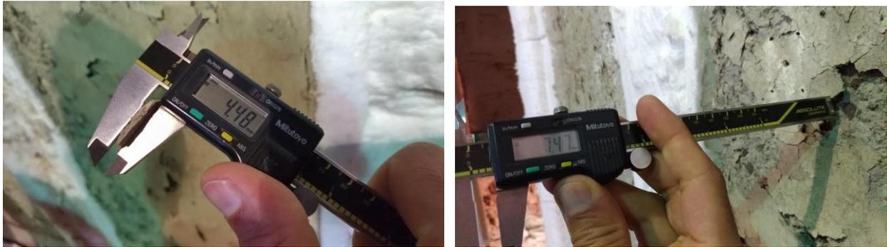
**Figura 79** – Detalhe das aferições do deslocamento entre 4,5 mm a 7,5 mm, na amostra de referência (sem revestimento).
