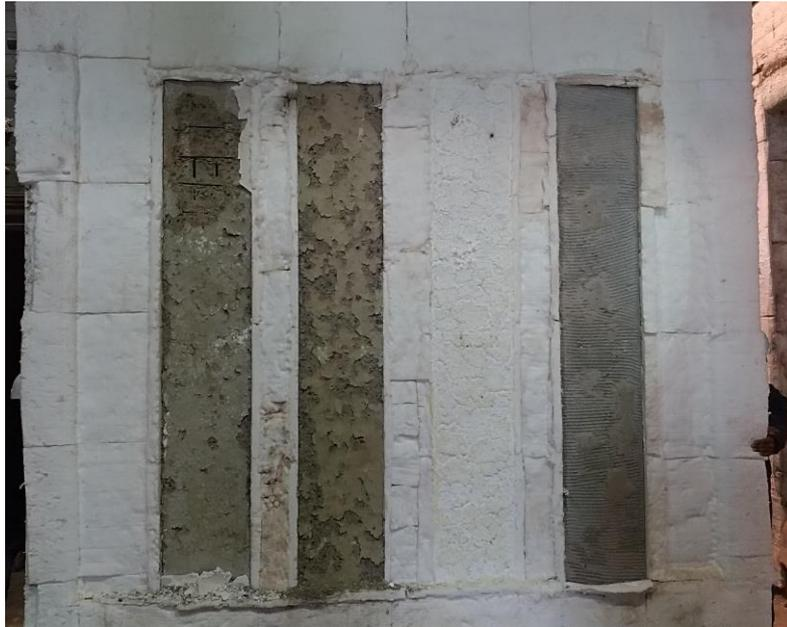
**Figura 73** – Detalhe da condição dos elementos e revestimentos, após abertura do forno (evento 2).
