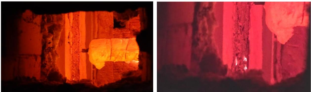
**Figura 72** – Detalhe da aparência de “elementos em brasa” do elemento revestido com tinta intumescente (coloração escura à esquerda) e impressão de pequenos pontos incandescentes nesse mesmo elemento (à direita).
