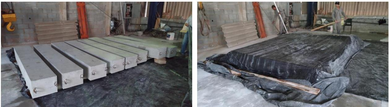
**Figura 32** – Detalhe dos elementos já posicionados para aplicação dos revestimentos e posteriormente cobertos/protegidos (pelo prazo de seis meses).
