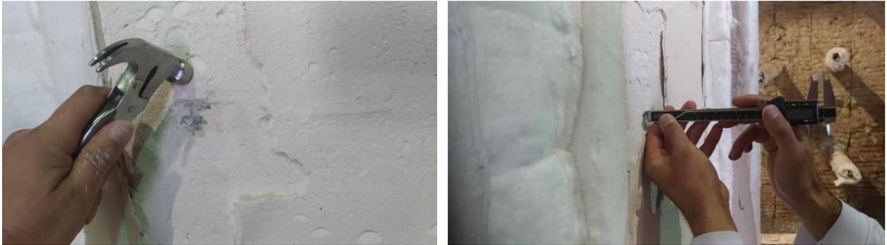
**Figura 57** – Verificação de som cavo, com uso de martelo de percussão, e aferição da espessura remanescente do revestimento em gesso projetado, com uso de paquímetro digital.
