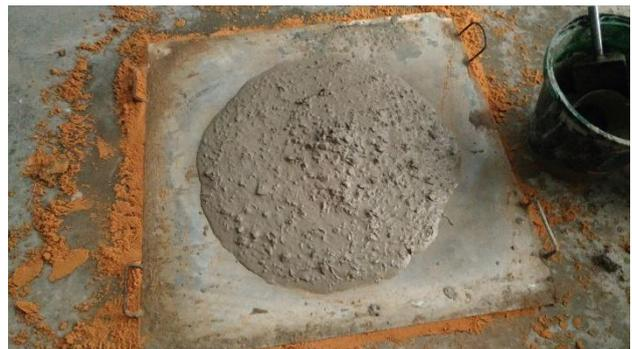
Figura 4 – Protótipo de 3 m x 3 m x 10 cm e espalhamento do concreto lançado (72 cm).
