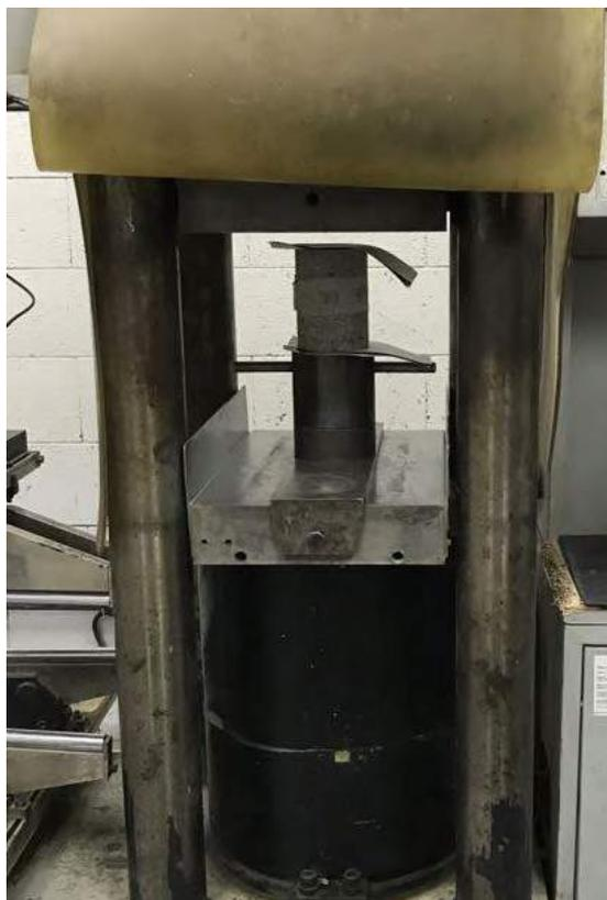
*Figura 8.9. Testemunho posicionado na prensa em momento prévio ao ensaio de resistência à compressão. (Fonte: acervo pessoal Paulo Helene)*
