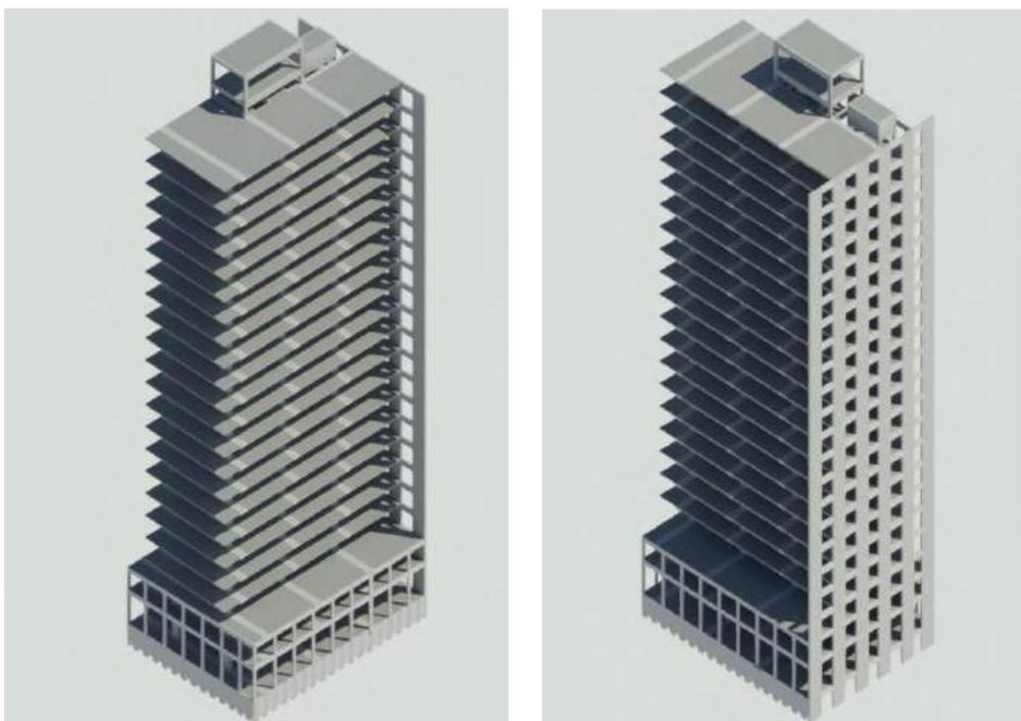
Figura 9.7. Perspectivas frontal e posterior da estrutura do Ed. Wilton Paes de Almeida (fonte: adaptado dos projetos existentes na FAU-USP, SPU e Revista Acrópole).
