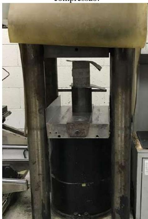
Também foram posicionadas duas folhas de papel-carbono para averiguar o contato das mesas superior e inferior da prensa com os topos dos testemunhos (Figs. 13 e 14).
