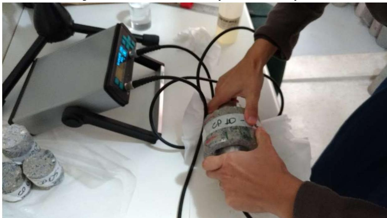
Figura 02 - Velocidade de onda ultrassônica.
