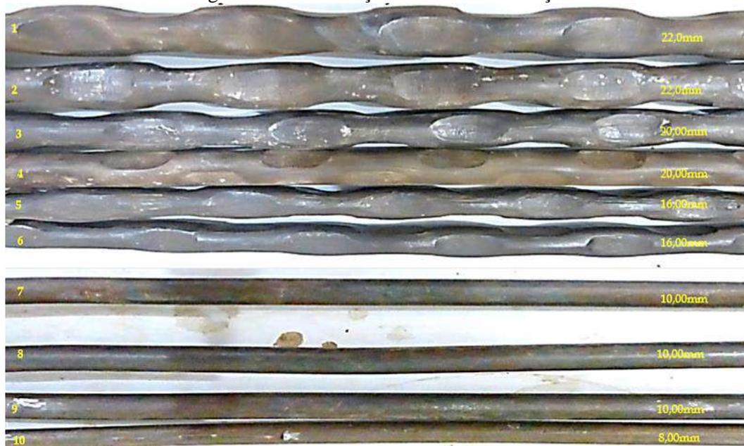
No caso especial do aço classificado como entalhado, é desconhecido o seu processo de fabricação, onde as depressões apresentadas de maneira uniformemente ordenadas variam sua angulação em 90°, conforme se observa na Fig. 16. Acredita-se que essa barra passou por um processo de “prensamento” no sentido das depressões. As medições e análises realizadas para as barras entalhadas estão apresentadas na Tabela 11.
