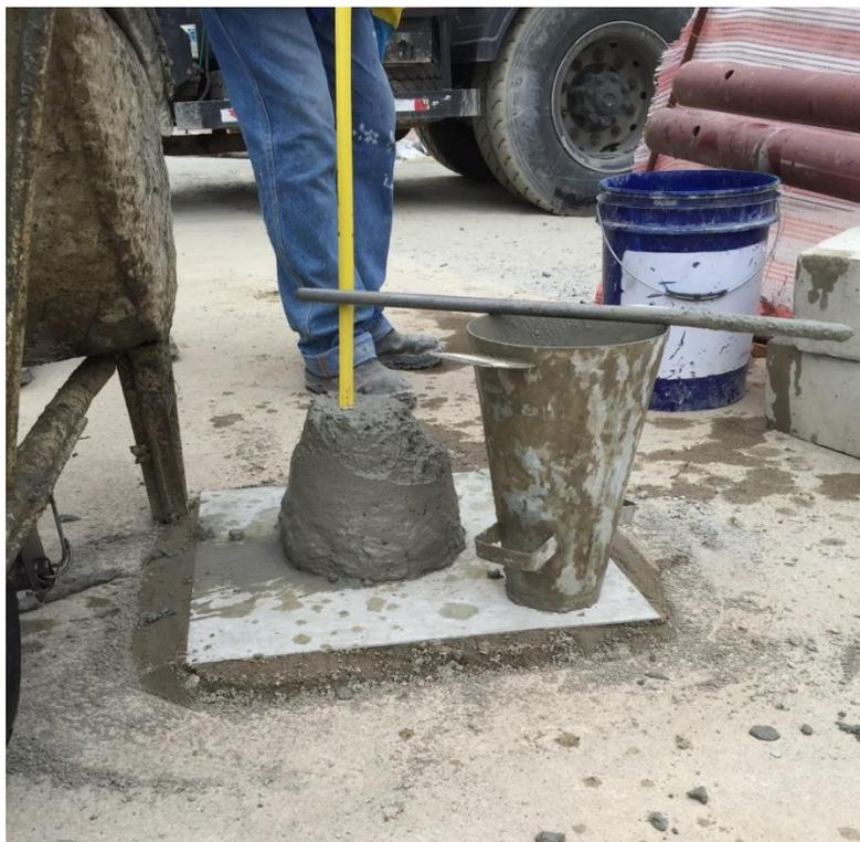
Figura 6.36 Ensaio de abatimento de tronco de cone realizado no concreto aplicado na Sapata.
