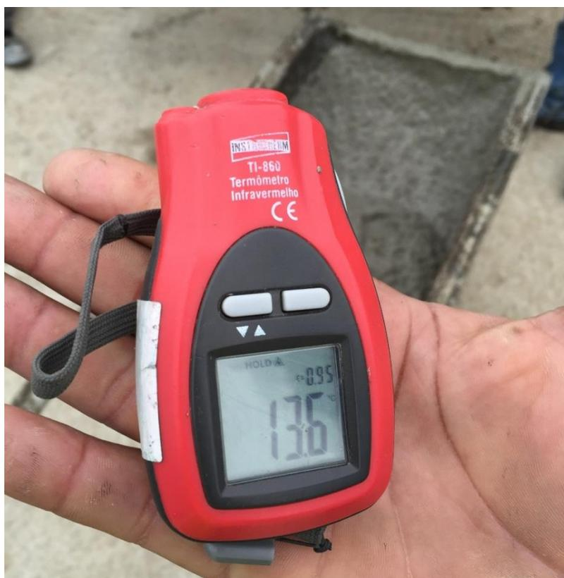
Figura 6.35 Verificação da temperatura no recebimento do concreto.
