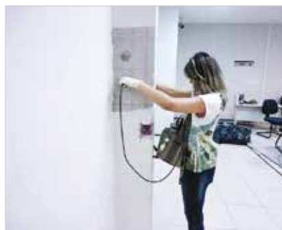
► Figura 3.4 Transdutores posicionados em faces opostas e realização do ensaio
