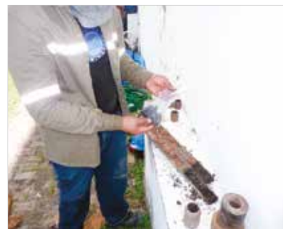
► Figura 3.3 Coleta do material utilizando uma perfuratriz para detectar a contaminação de cloretos
