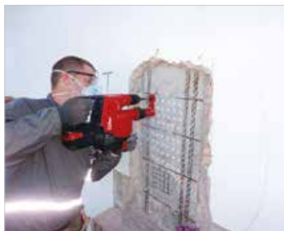
► Figura 3.3 Coleta do material utilizando uma perfuratriz para detectar a contaminação de cloretos
