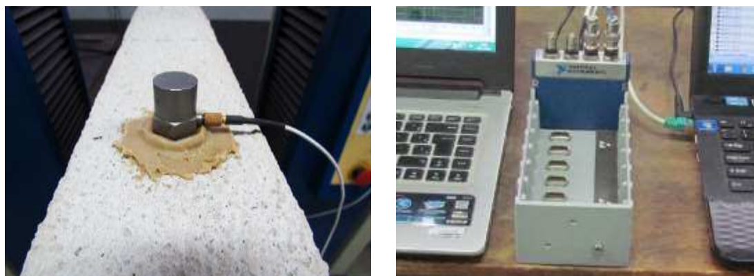
Figura 3.16 – Instrumentação do ensaio para determinação das características dinâmicas:
