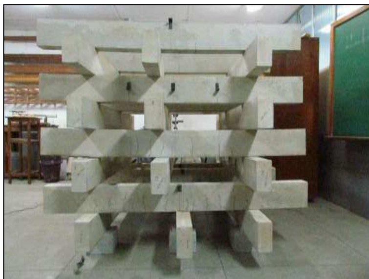
Figura 3.13 – Parte do conjunto das vigas ensaiadas.
