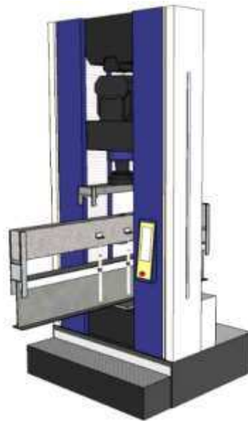
Figura 3.10 – Montagem geral do ensaio de flexão.
