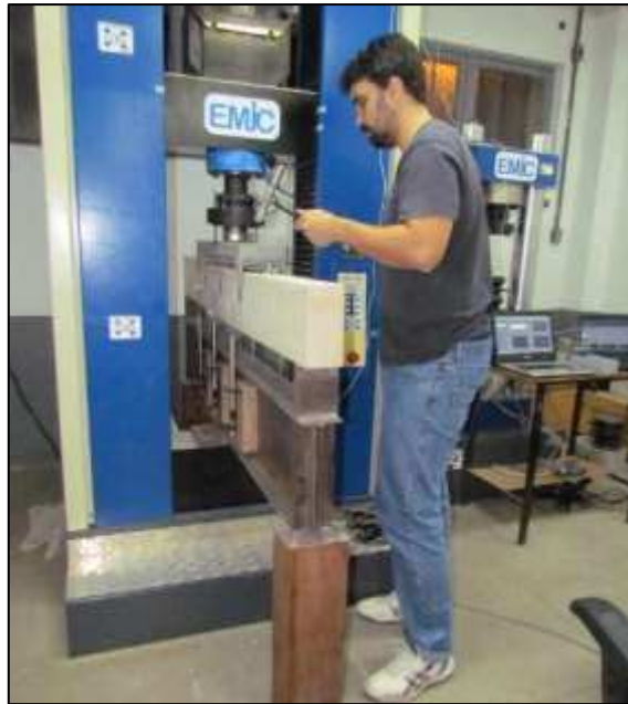
Figura 3.18 – Aplicação de impacto para obtenção da frequência fundamental.
