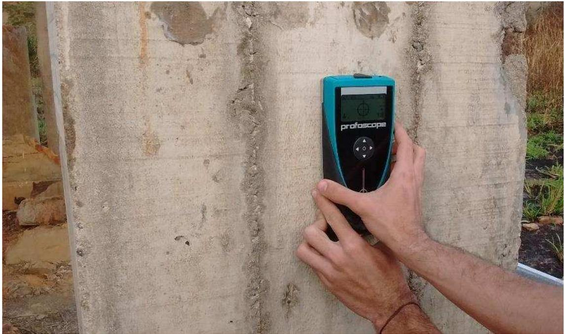
**Figura 3-16. Utilização do pacômetro para obtenção das características das armaduras.**
