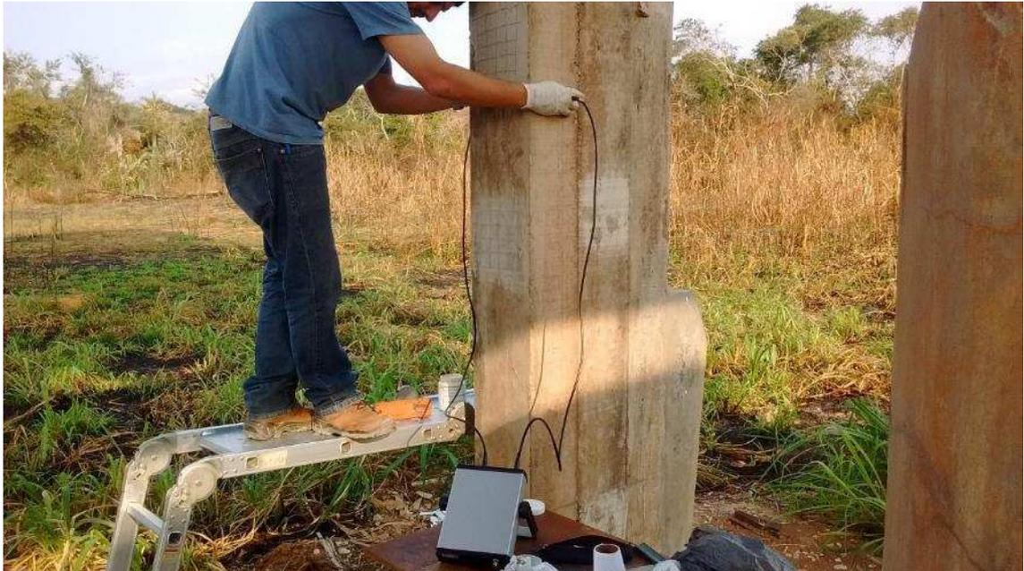
**Figura 3-14. Realização do ensaio de ultrassom nos pilares.**
