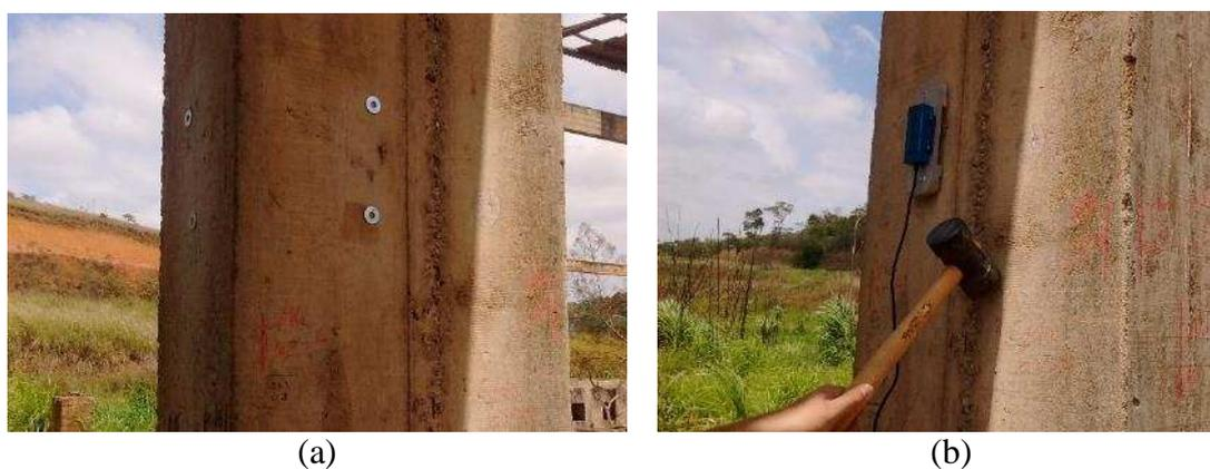
**Figura 3-17. Execução do ensaio dinâmico: (a) detalhe das arruelas metálicas utilizadas para fixação do acelerômetro; (b) impacto com marreta de borracha.**
