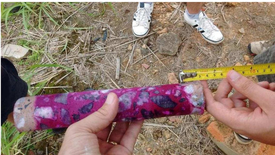
**Figura 3-15. Medição da frente de carbonatação com auxílio da solução de fenolftaleína.**
