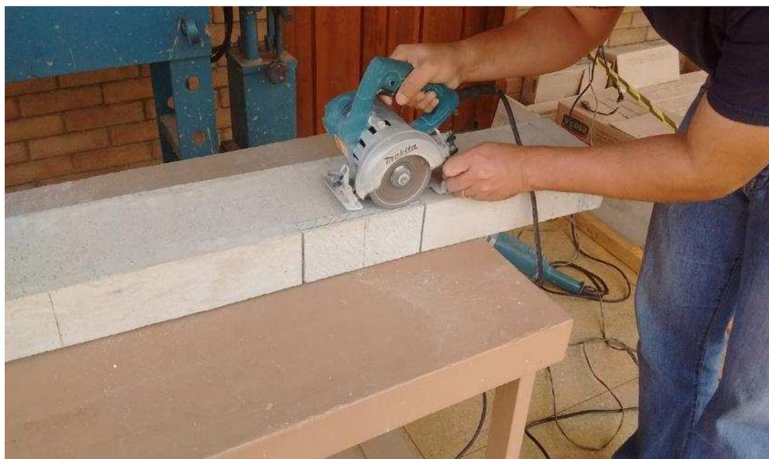
**Figura 3-3. Detalhe da produção do dano na viga.**
