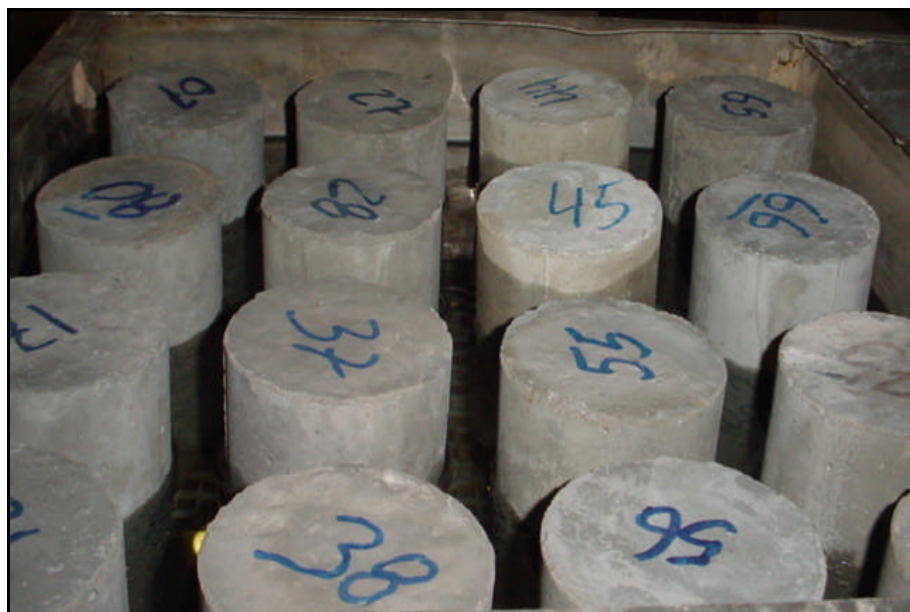
Figura 4.13 – Aspecto do ensaio de absorção por imersão em andamento
