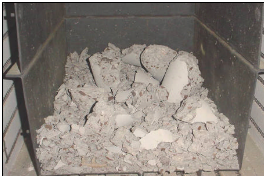
Figura 5.5 – Spalling nos concretos com adição de 10% de sílica-ativa e agregado basáltico
