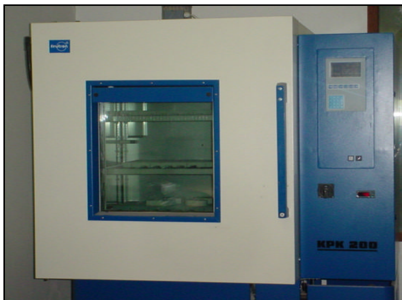
Figura 4.10 – Câmara climatizada utilizada para armazenar os corpos-de-prova em condição desidratada até o momento dos ensaios
