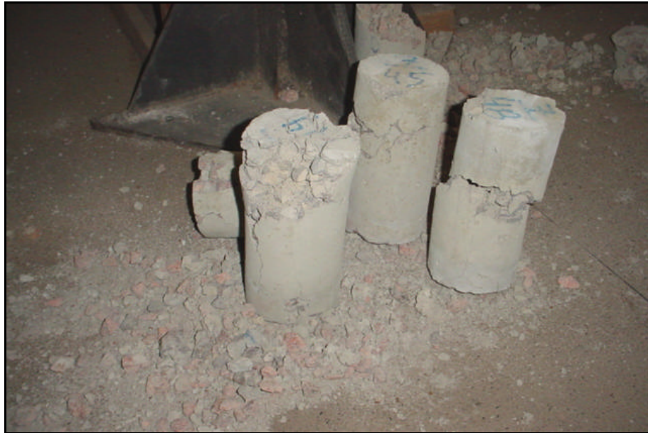
Figura 5.9 – Desagregação dos concretos com baixa compactidade à 900^{\circ}\text{C} durante o transporte
