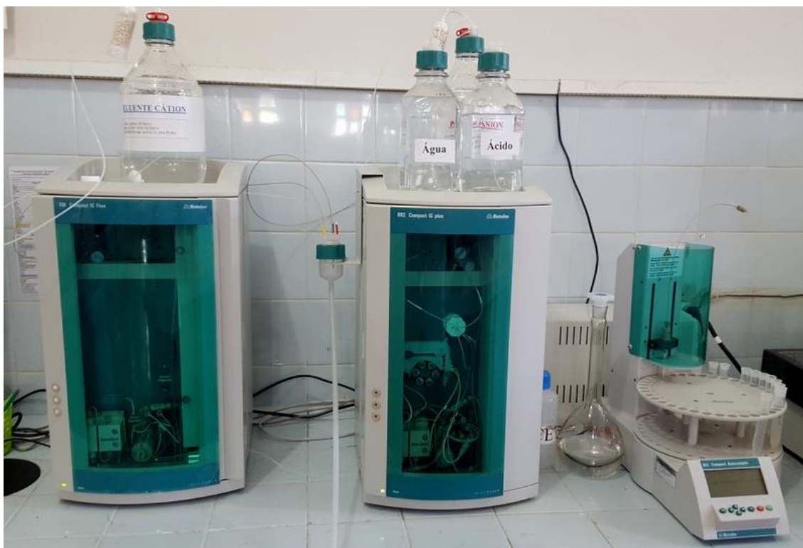
Figura 48 - Conjunto de equipamentos do cromatógrafo de íons
