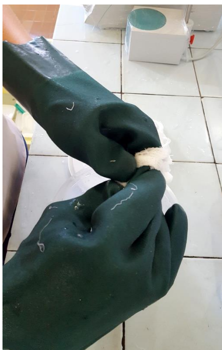
Figura 45 - A gaze sendo espremida para retirar os íons cloretos
