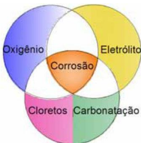
Figura 3 - Condições para ocorrência da corrosão
