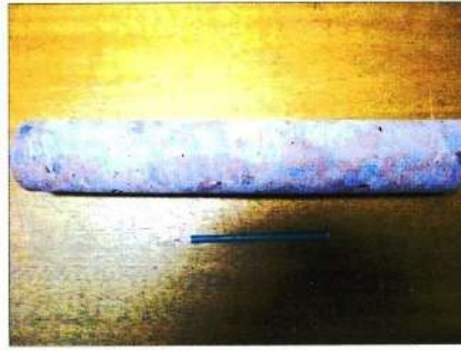
► Figura 3 Detalhe de algumas perfurações realizadas na extremidade do pilar e detalhe de um dos testemunhos extraídos (com \varnothing 75mm) para posterior ensaio de ruptura à compressão
