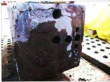
► Figura 3 Detalhe de algumas perfurações realizadas na extremidade do pilar e detalhe de um dos testemunhos extraídos (com \varnothing 75mm) para posterior ensaio de ruptura à compressão
