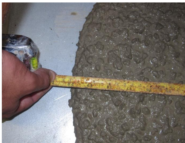
Figura 22 – Detalhe das bordas do espalhamento do concreto sem exsudação
