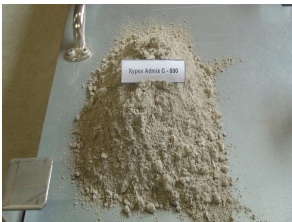
Figura 18 – Aspecto do aditivo catalisador cristalino fornecido na forma de pó
