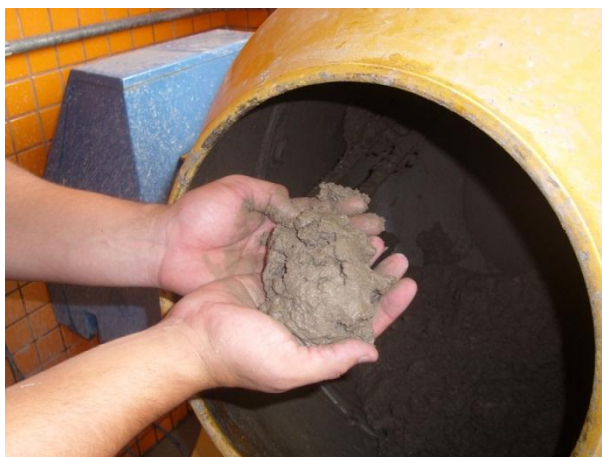
Figura 19 – Concreto sem aditivos químicos com consistência coesa e seca (abatimento de 0 cm).
