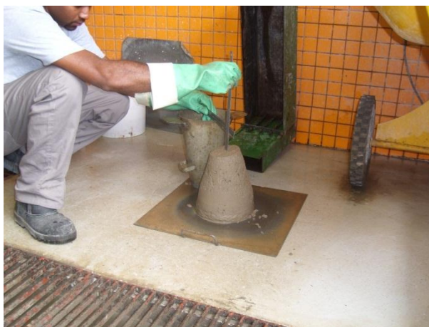
Figura 20 - - Concreto com aditivo superplastificante polifuncional com abatimento 8 cm.
