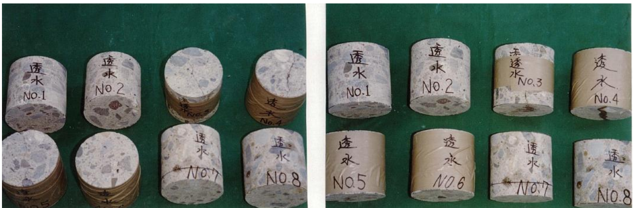
Figura 14 - Amostras para o ensaio de resistência à compressão axial e ensaio de permeabilidade (Fotos do autor)
