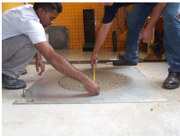
Figura 21 - – Concreto com superplastificante de policarboxilato com espalhamento > 700 mm.
