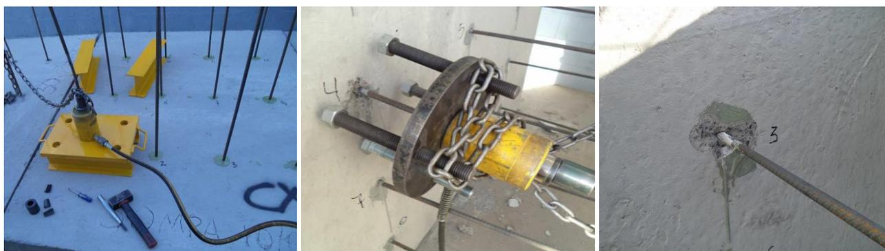
Figura 9 – Detalhe da realização dos ensaios com o produto B na posição vertical e horizontal no substrato nas condições seca e úmida.
