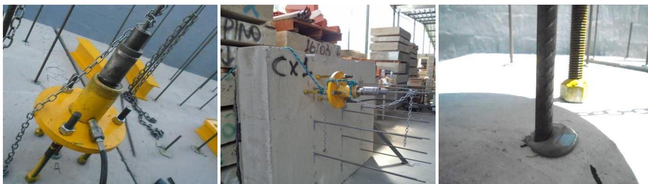
Figura 8 – Detalhe da realização dos ensaios com o produto A na posição vertical e horizontal no substrato nas condições seca e úmida
