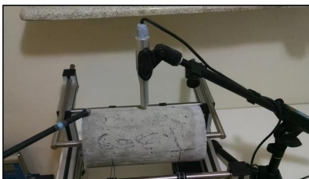
Figura 2. Forma de aplicação do estímulo por impulso e aquisição da resposta acústica, para frequência de ressonância fundamental transversal ( $G_c$ ).
