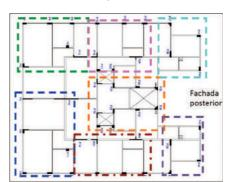
FIGURA 2 – ESQUEMA HIPOTÉTICO NA DETERMINAÇÃO DOS LOTES EM FUNÇÃO DO VOLUME DO CONCRETO REPRESENTADAS PELAS CORES
