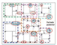
FIGURA 4 – PLANTA DA ESTRUTURA DOS PILARES ONDE SERÃO EXECUTADOS ENSAIOS ESCLEROMÉTRICOS E EXTRAÇÃO DE TESTEMUNHOS
