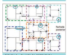
FIGURA 3 – PLANTA DA ESTRUTURA DOS PILARES ONDE SERÃO EXTRAÍDOS TESTEMUNHOS DE CONCRETO REPRESENTATIVOS DOS LOTES
