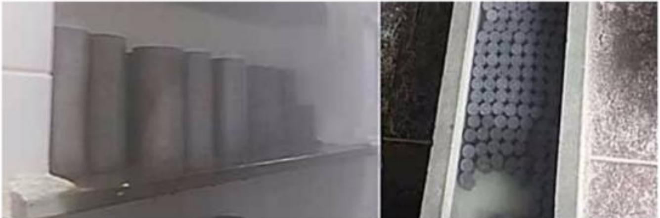
Figura 3. A la izquierda tenemos la disposición correcta de la cámara de humedad, la humedad por encima del 95 por ciento, nebulización de agua, y a la derecha el curado de tanque.
