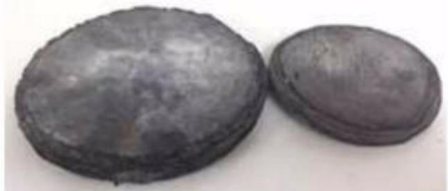
Figura 7. Ejemplos de tapones de neopreno en mal estado.
