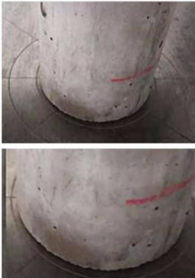
Figura 10. Ejemplo de error aleatorio: probeta descentrada en la máquina de ensayo.
