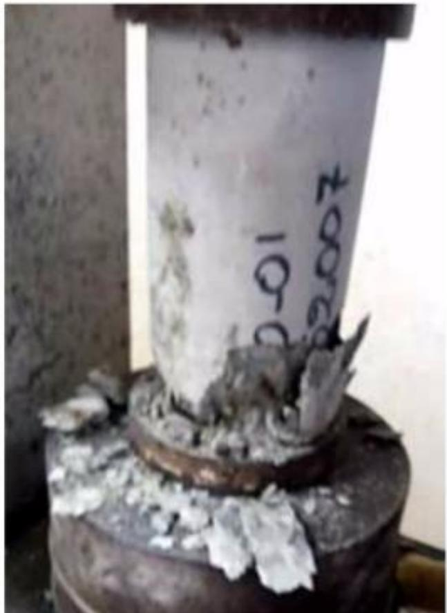
Figura 8. Probeta con fractura en la región periférica y el tipo de configuración de rotura de probeta F o G, lo que sugiere concentración de carga indebida.
