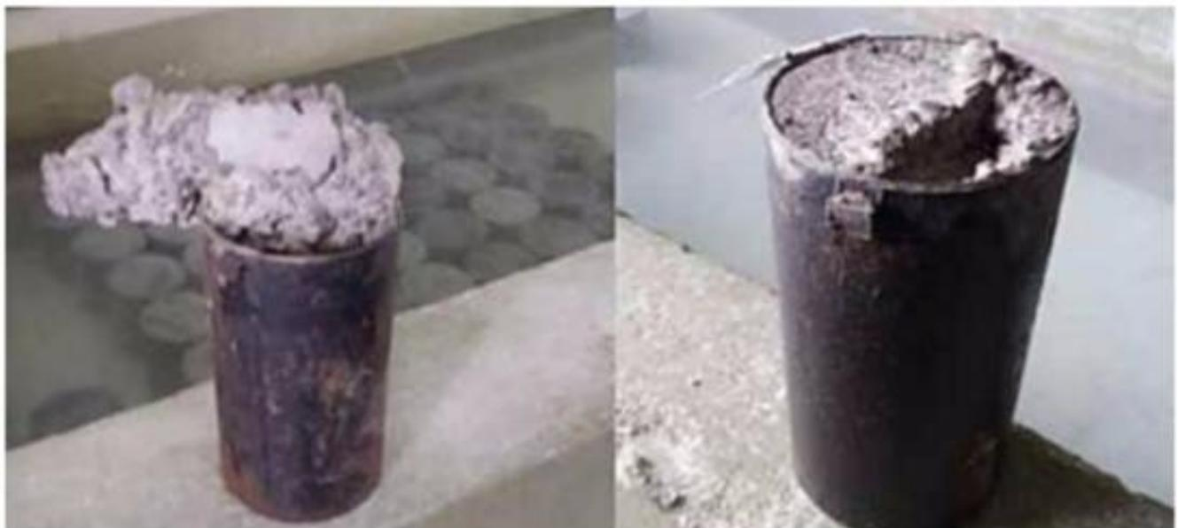
Figura 1. Ejemplo falta de cuidado para la preservación de probetas.
