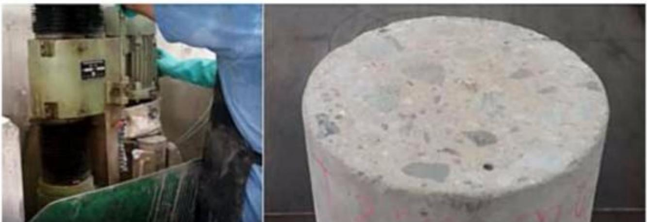
Figura 5. Fresa pulidora y la parte superior de la probeta bien preparada.
