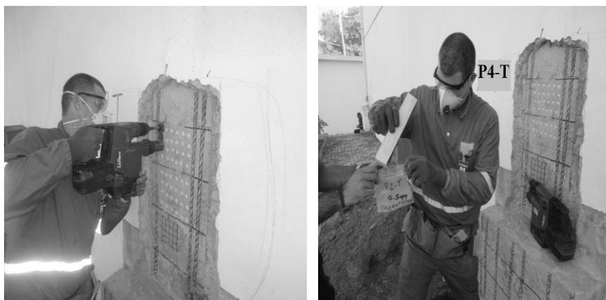
Figura 3.3: Coleta do material utilizando uma perfuratriz para detectar a contaminação de cloretos.
