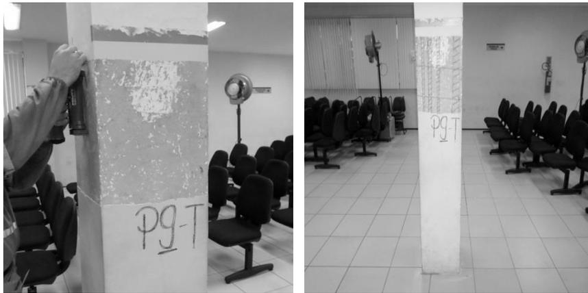
Figura 3.1: Procedimento realizado para detectar o posicionamento das armaduras utilizando o pacômetro “HILTI-Ferroskan”.
