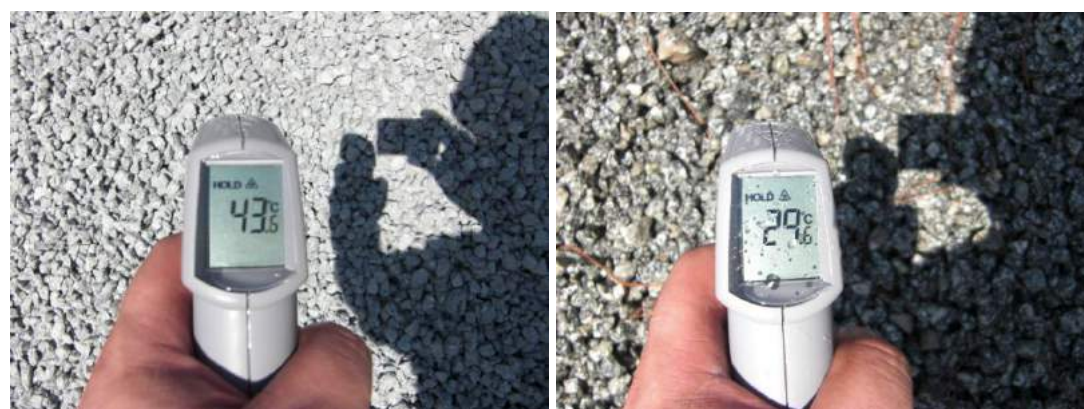
Figura 7. Registros de la temperatura del árido grueso antes y después de haber sido rociado con agua en la planta dosificadora de la Compañía de Hormigón Premezclado.
