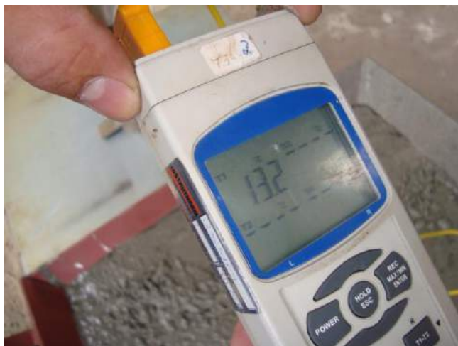
Figura 8. La temperatura del hormigón fresco se controlaba para cada camión hormigonera mediante un termómetro digital de inmersión (ejemplo: 13.2°C).
