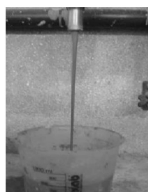
Figura 3.60: cone Marsh durante ensaio (Lemos e Melo, 2012).
