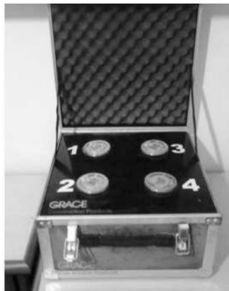
Figura 3.64: Calorímetro semi-adiabático AdiaCal (Fracalossi et al. , 2012).
