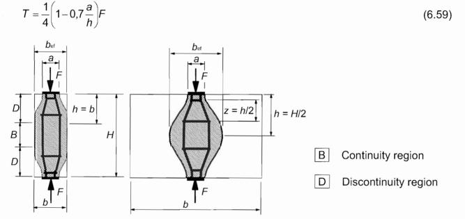
$b_{ef} = b$   $b_{ef} = 0,5H + 0,65a; a \le h$
