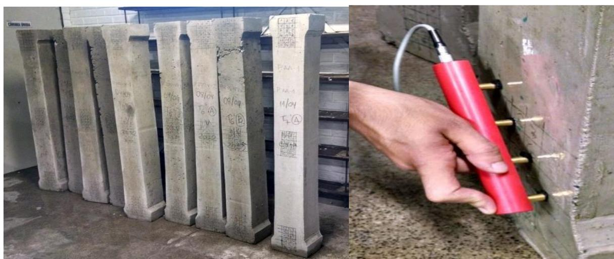
Figura 2: Pilares úmidos e o bastão de quatro pinos para determinação da resistividade elétrica do concreto
