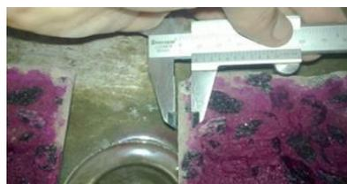
Figura 4. Medição da carbonatação.
