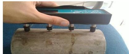
Figura 2. Medição da resistividade elétrica.
