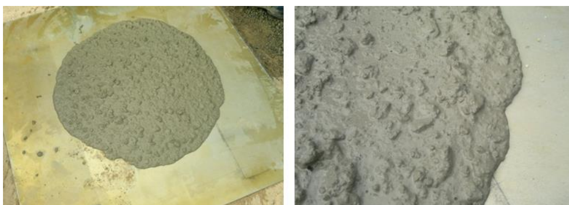
Figura 8 – Detalhe do espalhamento e do aspecto visual do concreto auto-adensável utilizado na Sapata S3B.
