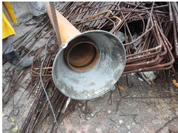
(b) Detalhe do tubo com balde metálico “sem fundo” adaptado na extremidade superior a ser inserido no protótipo.
