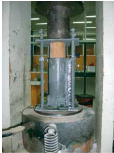
Figura 17 – Aparato para aplicação de pressão no CPR no estado fresco (CHRIST, 2011).
