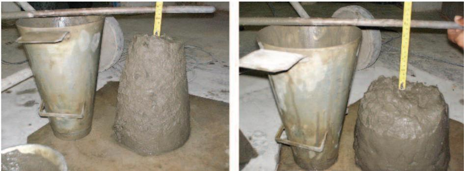
Figura 14. Dois concretos produzidos com o mesmo cimento e agregados e com 0,60 de relação água/cimento, dosados para terem abatimentos distintos (60mm e 140mm).
