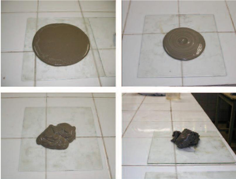
Figura 13 - Pasta do mesmo cimento Portland com diferentes relações água/cimento: da esquerda para direita e de cima para baixo: 0,60, 0,50, 0,40 e 0,30.
