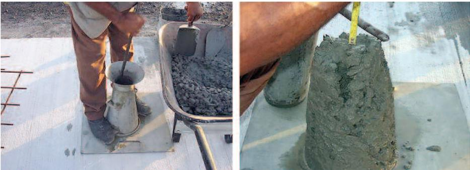
Figura 16 - Ensaio de abatimento pelo método do abatimento do tronco de cone, para medida da consistência do concreto fresco. NBR NM 67 (ABNT, 1996)
