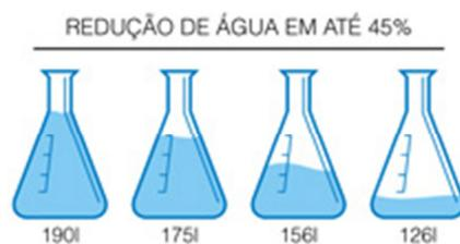
Figura 10 – Esquema ilustrativo da redução de água do hiperplastificante (Fonte: Basf)
