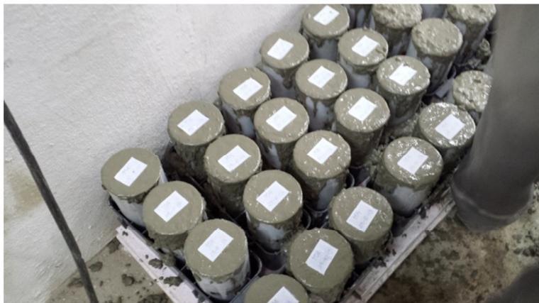
Foto 3 – Moldagem de corpos de prova cilíndrico 100 x 200 mm
