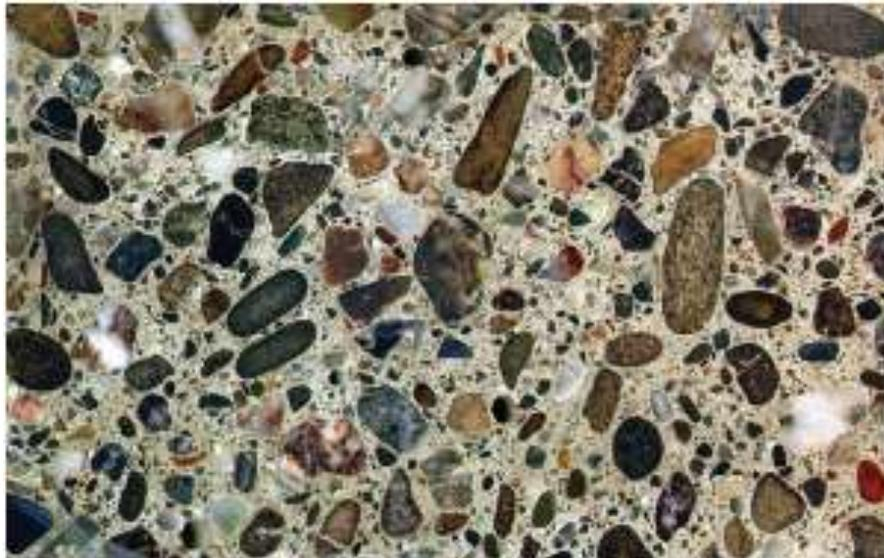
**Figura 2.5** – Seção polida de um corpo de prova de concreto, parte visível à olho nu. (Estrutura Macroscópica)
