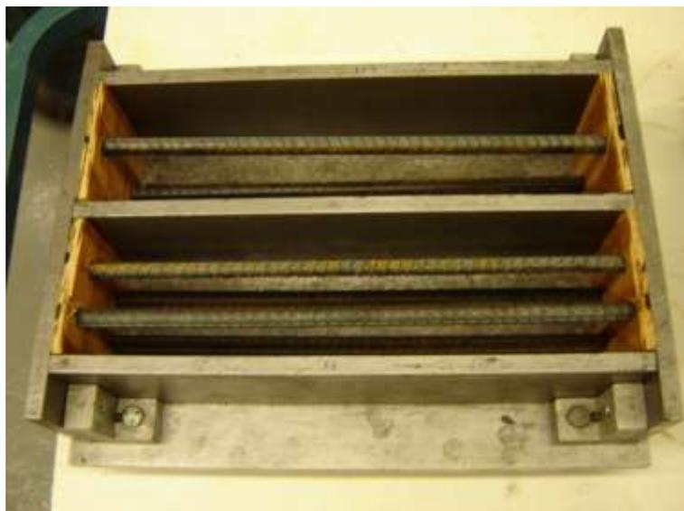
Figura 5. 22 - Molde para prisma com barras para restringir expansão.
