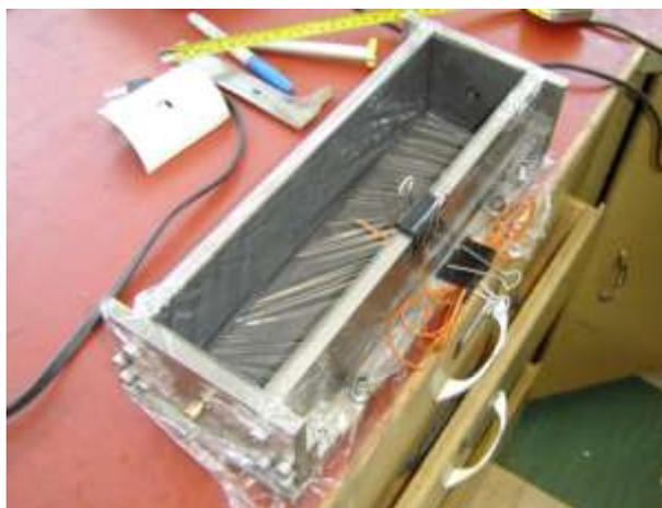
Figura 5. 5 - Fôrmas preparadas para receber o concreto.
