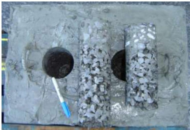
**Figura 5. 41 - Furos feitos na face superior do prisma para uso de vibrador.**
