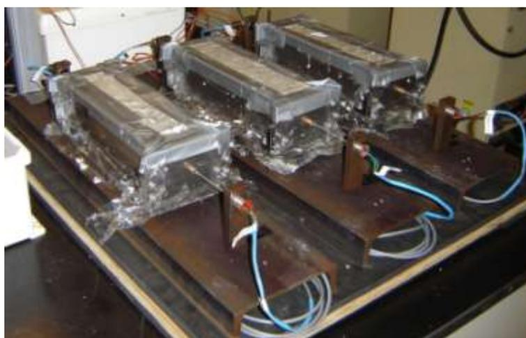
**Figura 5. 11 - Moldes preenchidos, com a cobertura plástica colocada e acoplados ao sistema.**
