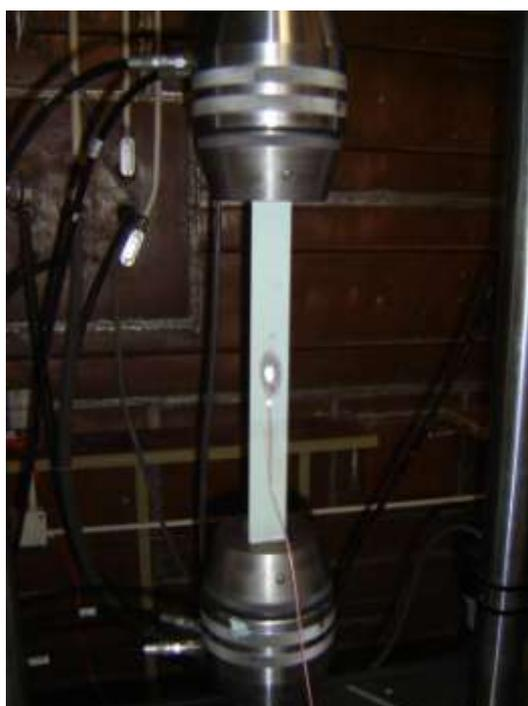
**Figura 5. 49 - Long gauge na prensa para teste de expansibilidade e linearidade.**
