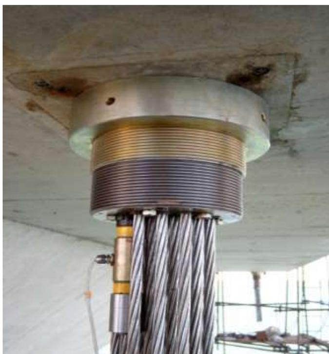
Figura 2. 3 - Célula de carga montada em cabo de sustentação de ponte (ALMEIDA et al., 2006).
