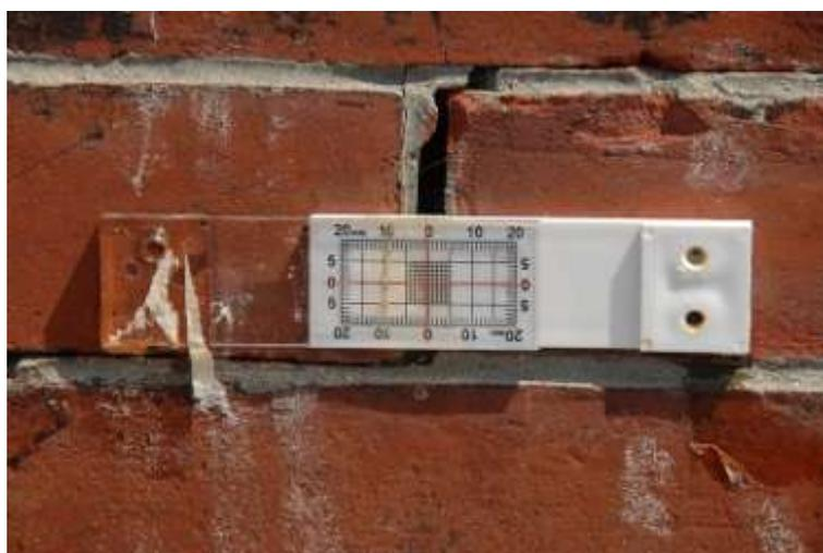
Figura 2. 2 - Sensor mecânico usado para medir desenvolvimento de fissuras ao longo do tempo (LEE; SESHIA, 2010).
