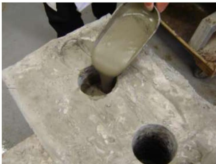
**Figura 5. 43 - introdução da pasta expansiva no prisma.**
