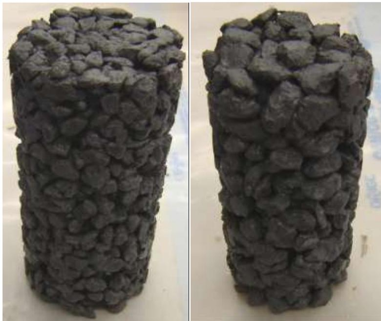
Figura 5. 28 - Cilindros moldado com concreto permeável utilizando brita A (esq.) e B (dir.).
