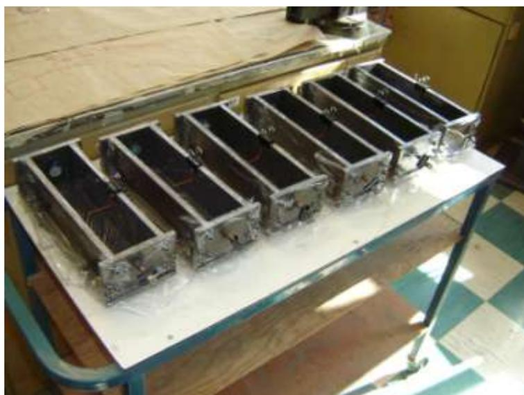
**Figura 5. 9 - Moldes prontos para receber o concreto.**
