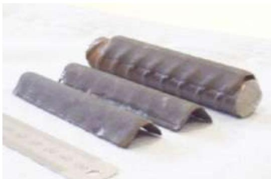
**Figura 3. 11 - Foto da proteção de polímero reforçado com fibras de carbono usada no projeto. (KISTER et. al., 2007)**
