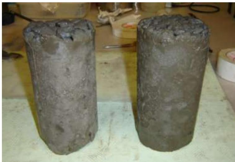
**Figura 5. 30 - Cilindros com revestimento aplicado.**
