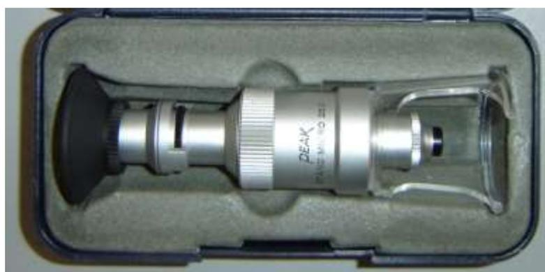
Figura 5. 51 - Crack scope usado para leituras de referência.
