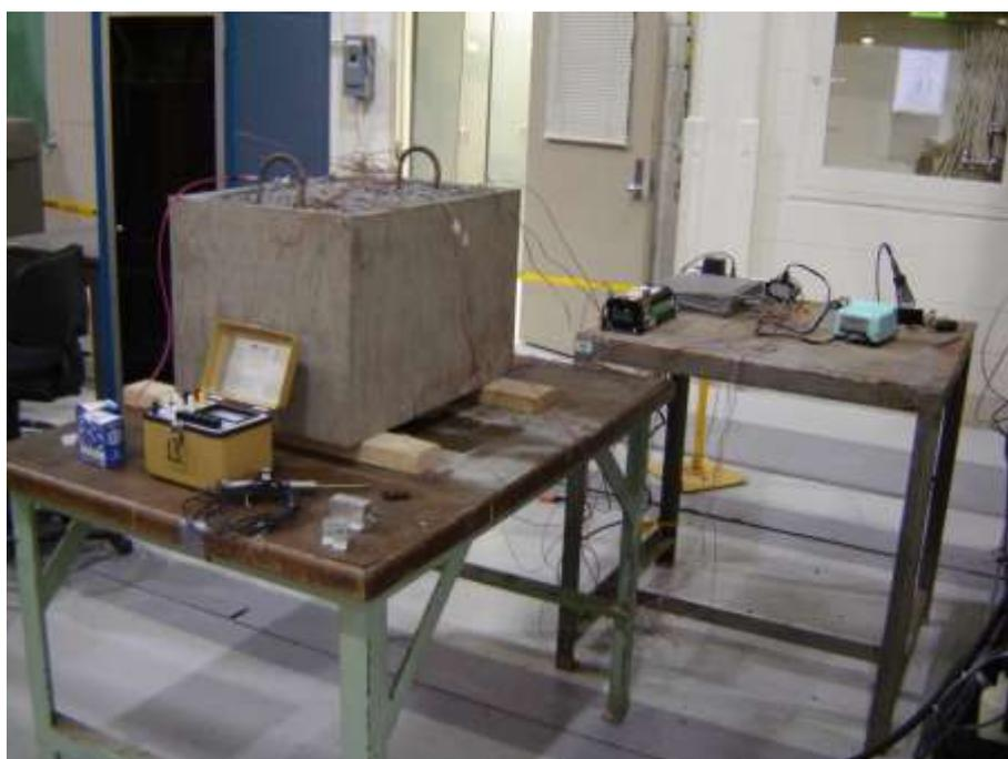
**Figura 5. 53 - Prisma na bancada aguardando instalação dos sensores superficiais.**
