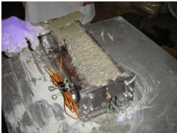
**Figura 5. 10 - Regularização de superfície em CP de concreto expansível na mesa vibratória.**
