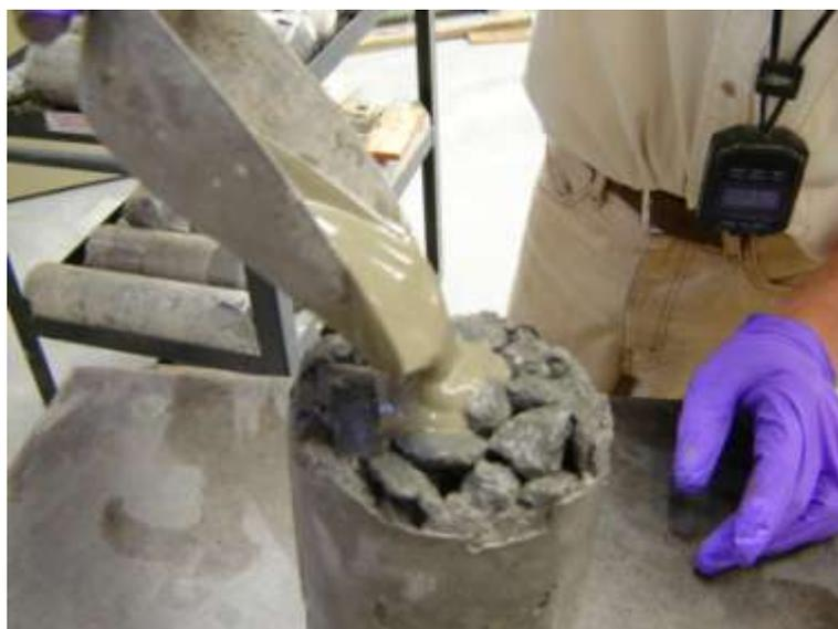
**Figura 5. 31 - Pasta expansiva sendo introduzida em um cilindro.**
