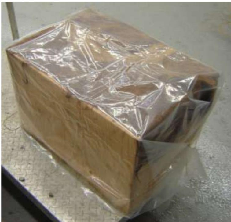
**Figura 5. 38 - Prisma de concreto permeável sob cura úmida.**
