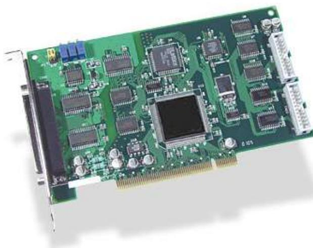
**Figura 2. 10 – Exemplo de uma placa de aquisição de dados com interface PCI. Fonte: OMEGA (2011).**
