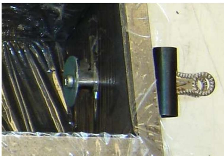
Figura 5. 7 - Disco de ancoragem do LVDT no concreto.
