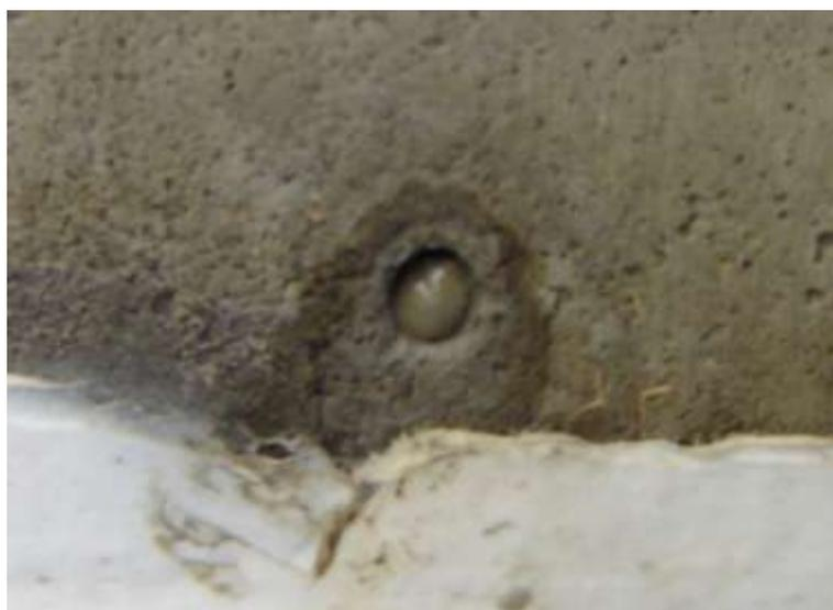
**Figura 5. 42 - Pasta expansiva escorrendo por um dreno do prisma.**
