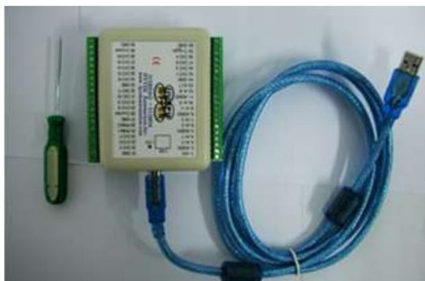
**Figura 2. 13 - Exemplo de módulo de aquisição USB. Fonte: HYTEK AUTOMATION (2011)**
