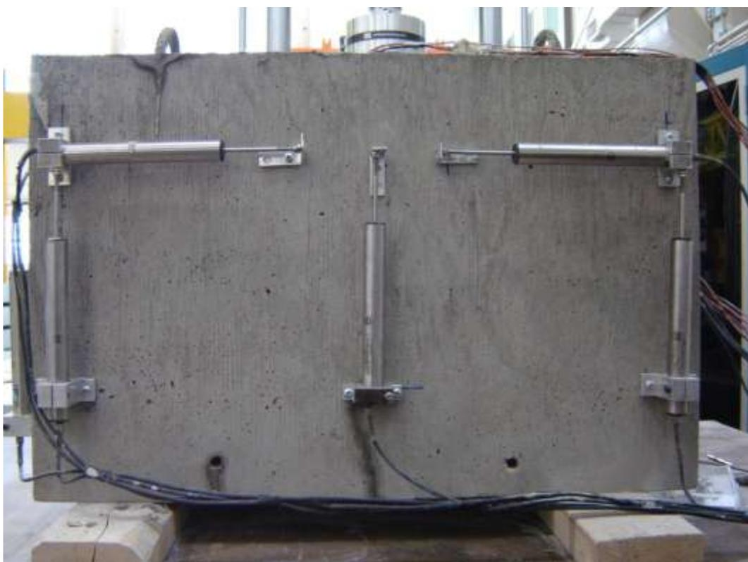
**Figura 5. 54 - Face N com sensores aplicados.**
