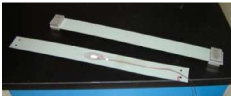
**Figura 5. 48 - Long gauges para aplicação na superfície.**
