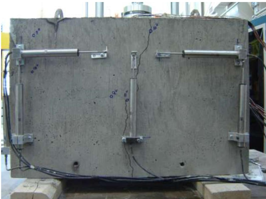
Figura 5. 57 - Face com pontos de medição de fissura marcados.
