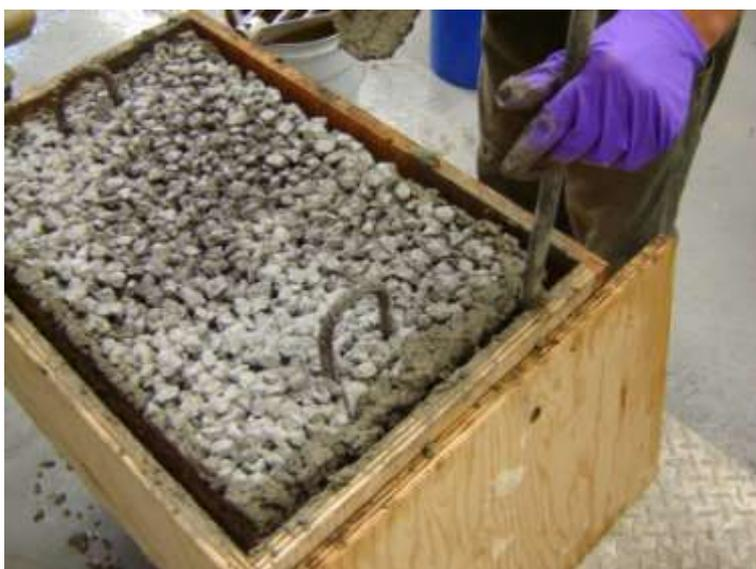
**Figura 5. 39 - Adensamento da camada de argamassa.**
