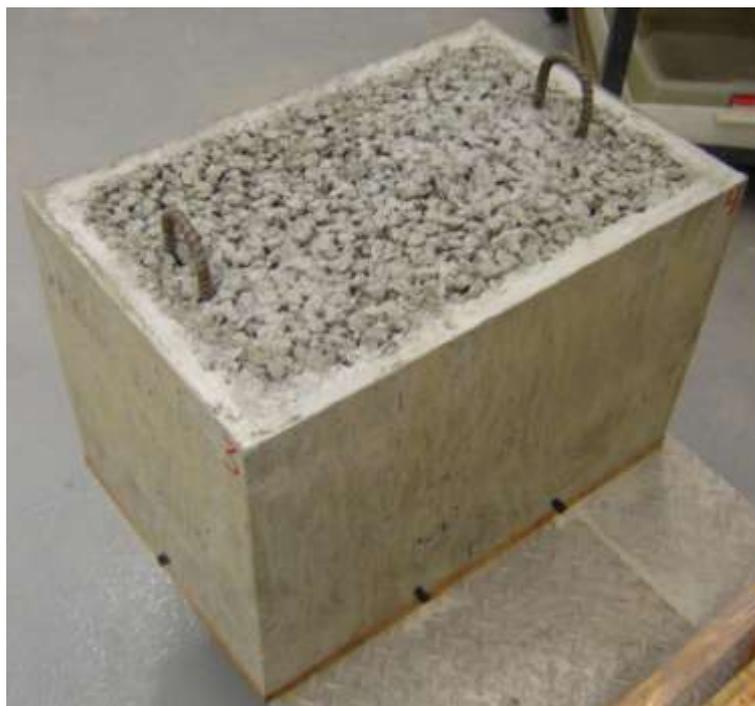
**Figura 5. 40 - Prisma para simulação de RAA com drenos vedados.**
