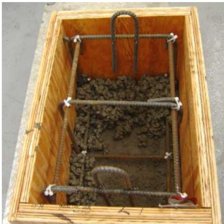
Figura 5. 37 - Preenchimento da fôrma com concreto permeável.
