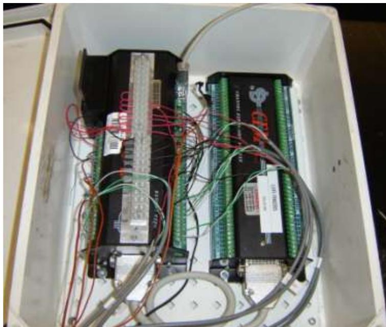
**Figura 5. 8 - DataTaker DT500 usado no experimento com o módulo de expansão de canais acoplado.**
