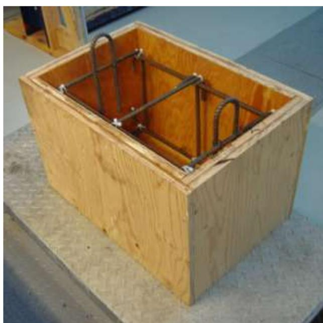
Figura 5. 34 - Fôrma com 2 camadas de madeira para confecção do prisma.
