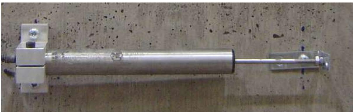
Figura 5. 46 - LVDT aplicado à superfície do prisma.
