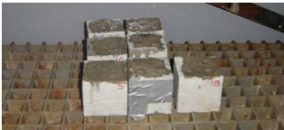
Figura 5. 26 - Cubos na câmara úmida.
