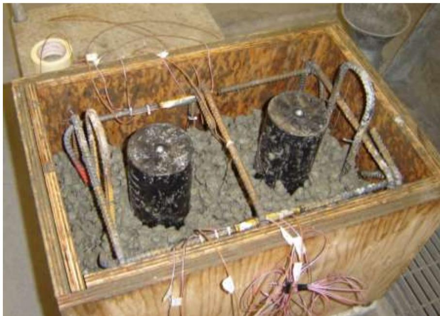
**Figura 5. 45 - Moldes 15x30 colocados no prisma para deixar o espaço necessário ao uso do vibrador.**
