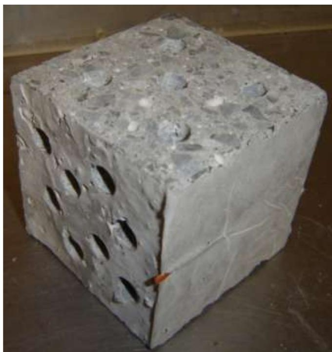
Figura 5. 25 - Bloco com furos aleatórios para preenchimento com pasta expansiva.
