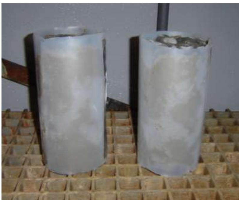
**Figura 5. 29 - Cilindros de concreto permeável com o revestimento ainda no molde.**
