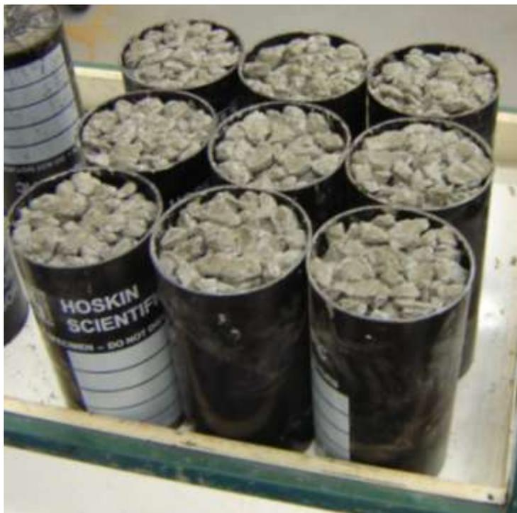
Figura 5. 27 - Corpos de prova ainda nas fôrmas plásticas.
