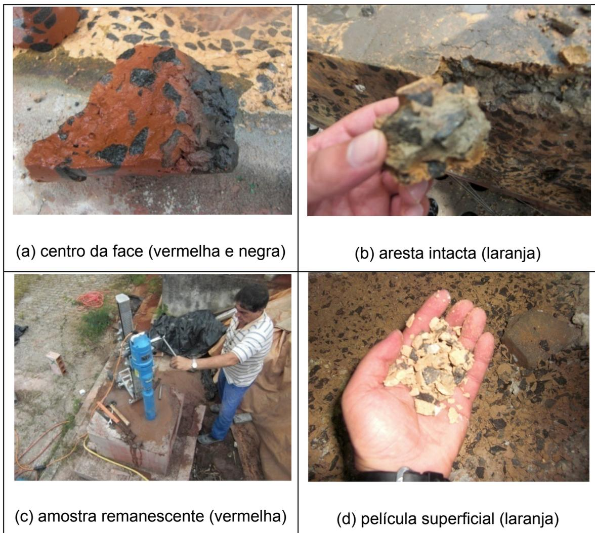
**Figura 120** – Detalhe das amostras extraídas para ensaios de caracterização mineralógica e de análises térmicas.
