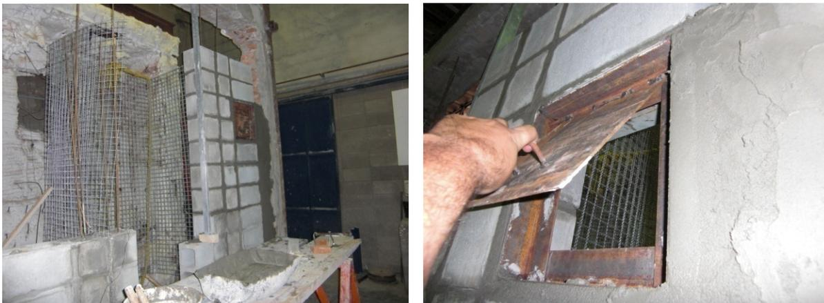
**Figura 93** – Detalhe da alvenaria e das janelas de inspeção.
