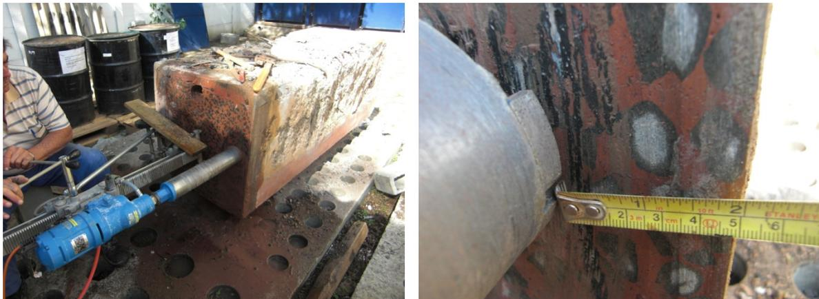
**Figura 116** – Detalhe da perfuração realizada a 50mm de uma das faces do pilar exposta ao fogo: na proximidade da fronteira com a parte escura no interior do pilar (vide Fig. 110).
