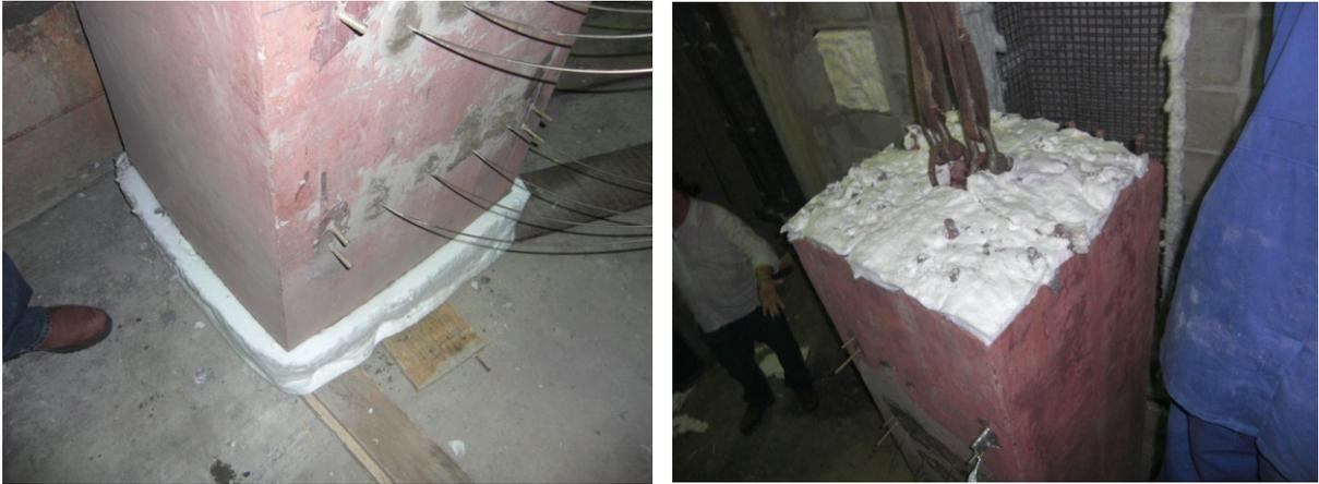
**Figura 99** – Detalhe do isolamento das extremidades do pilar com manta de fibra cerâmica.
