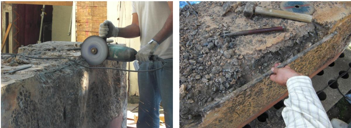
**Figura 118** – Detalhe da extração das amostras de aço longitudinal (na região da aresta que foi submetida as mais elevadas temperaturas).
