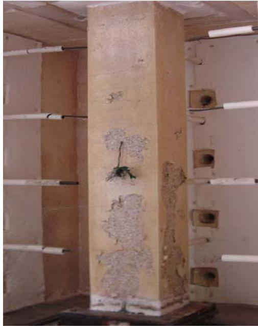
**Figura 48** – Condições do pilar com espessura de cobrimento de 40mm após o experimento de simulação de incêndio (Park e Lee, 2008).
