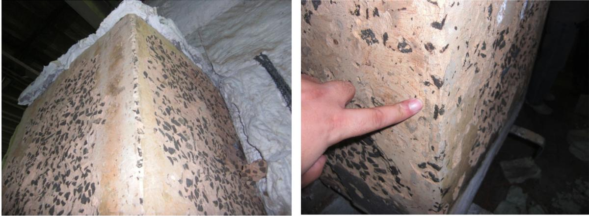
**Figura 105** – Detalhe das arestas intactas, posterior ao evento de simulação de incêndio.
