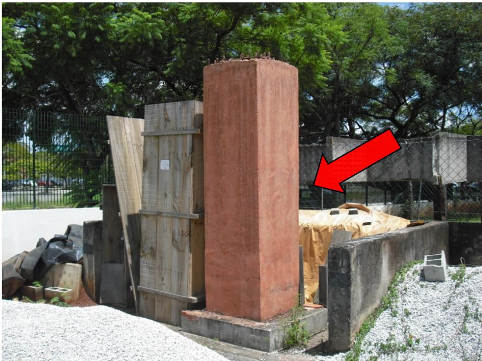
**Figura 55** – Réplica do pilar protótipo de concreto colorido de alta resistência do edifício e-Tower, construída no pátio do Laboratório de Materiais de Construção Civil da Escola Politécnica da Universidade de São Paulo.
