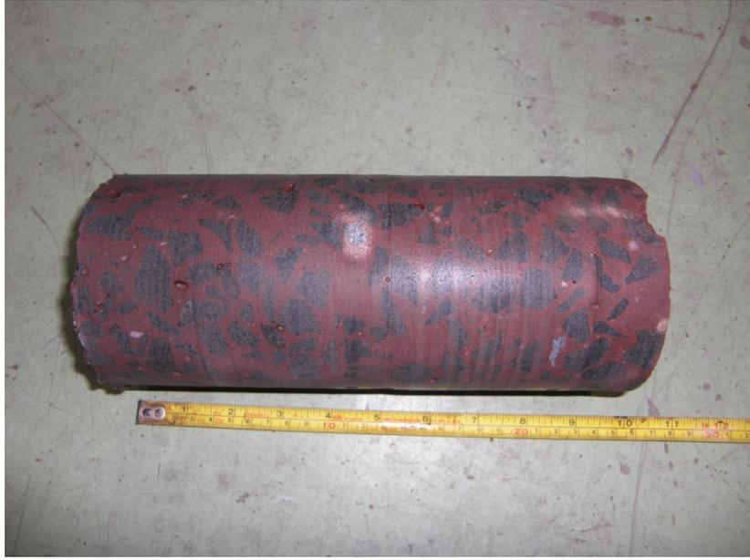
**Figura 60** – Detalhe de um dos testemunhos extraídos (idade de oito anos).
