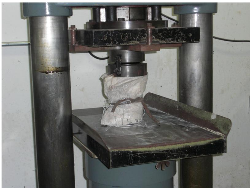
**Figura 63** – Procedimento de ruptura do testemunho cilíndrico. Observa-se que o testemunho está protegido em virtude do risco de ruptura tipo explosiva.
