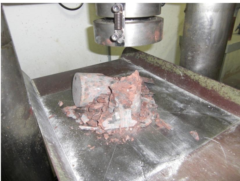
**Figura 65** – Detalhe de um dos testemunhos já rompido.
