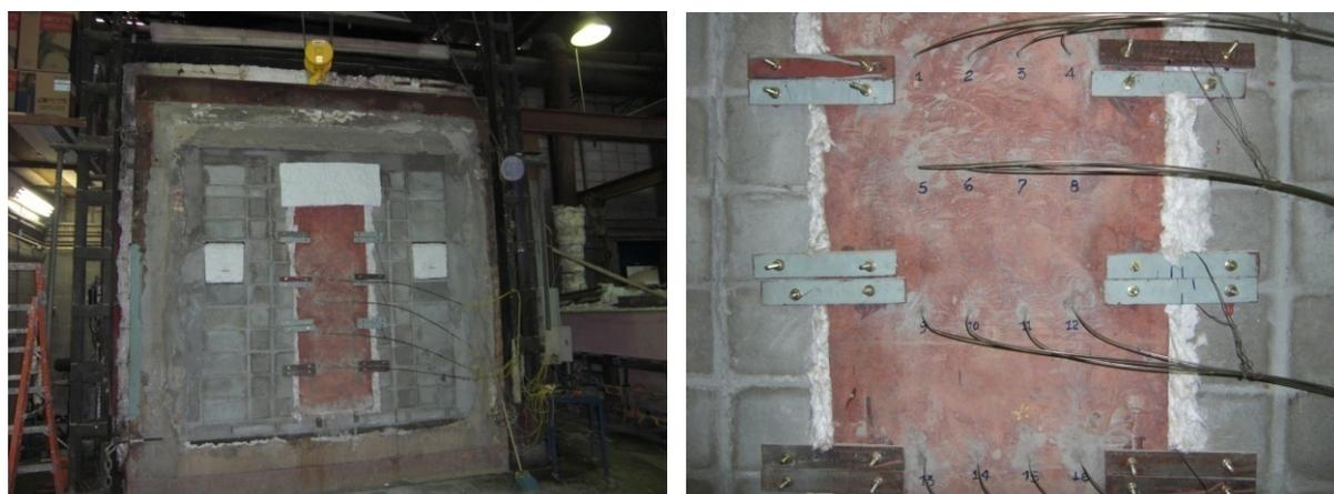
**Figura 98** – Esquema final para o experimento de simulação de incêndio e detalhe dos dezesseis termopares instalados através da face externa da amostra.
