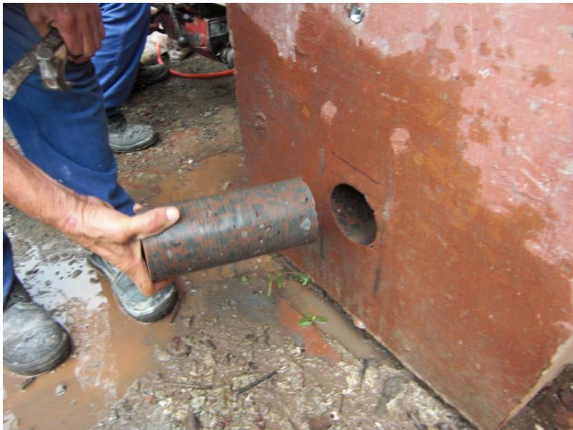
**Figura 59** – Detalhe de um dos testemunhos extraídos.
