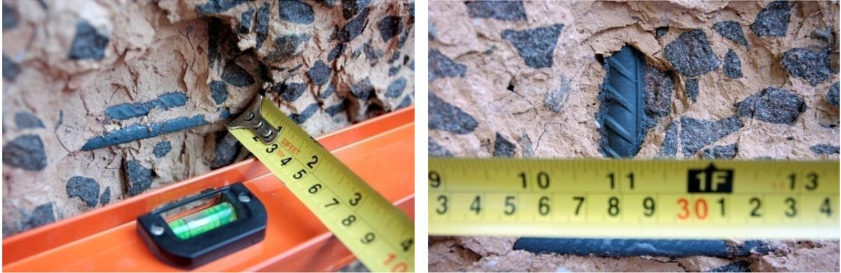
**Figura 106** – Detalhes da pouca exposição da armadura nas faces do pilar, posterior ao evento de simulação de incêndio.
