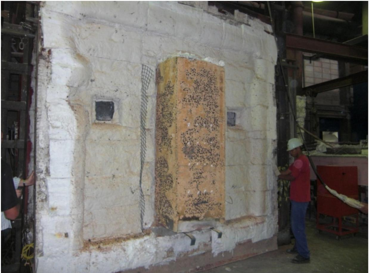
**Figura 102** – Visão geral do pilar protótipo, posterior ao experimento de simulação de incêndio (instante de remoção da câmara do forno).
