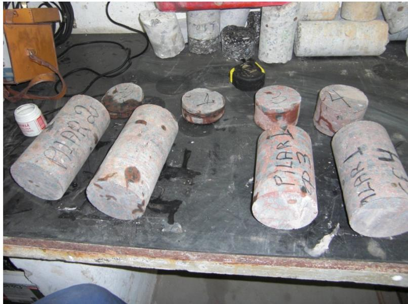
**Figura 61** – Detalhe dos testemunhos extraídos já preparados para posterior exame de ultrassom.
