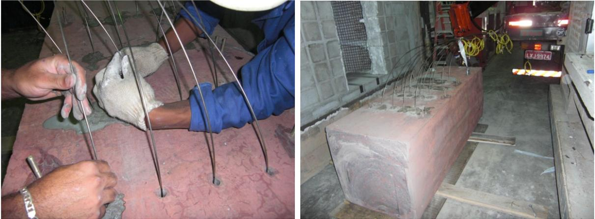
**Figura 83** – Procedimento de fixação dos termopares com uso de graute de alta resistência no pilar horizontalizado.
