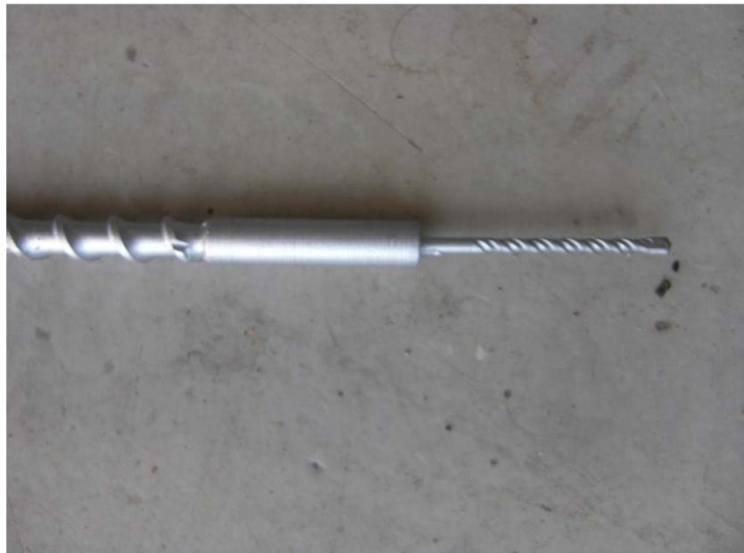
**Figura 74** – Detalhe da ponta da broca especial (redução de  $\varnothing$  12,5mm para  $\varnothing$  4mm) utilizada no procedimento de perfuração para instalação dos termopares.
