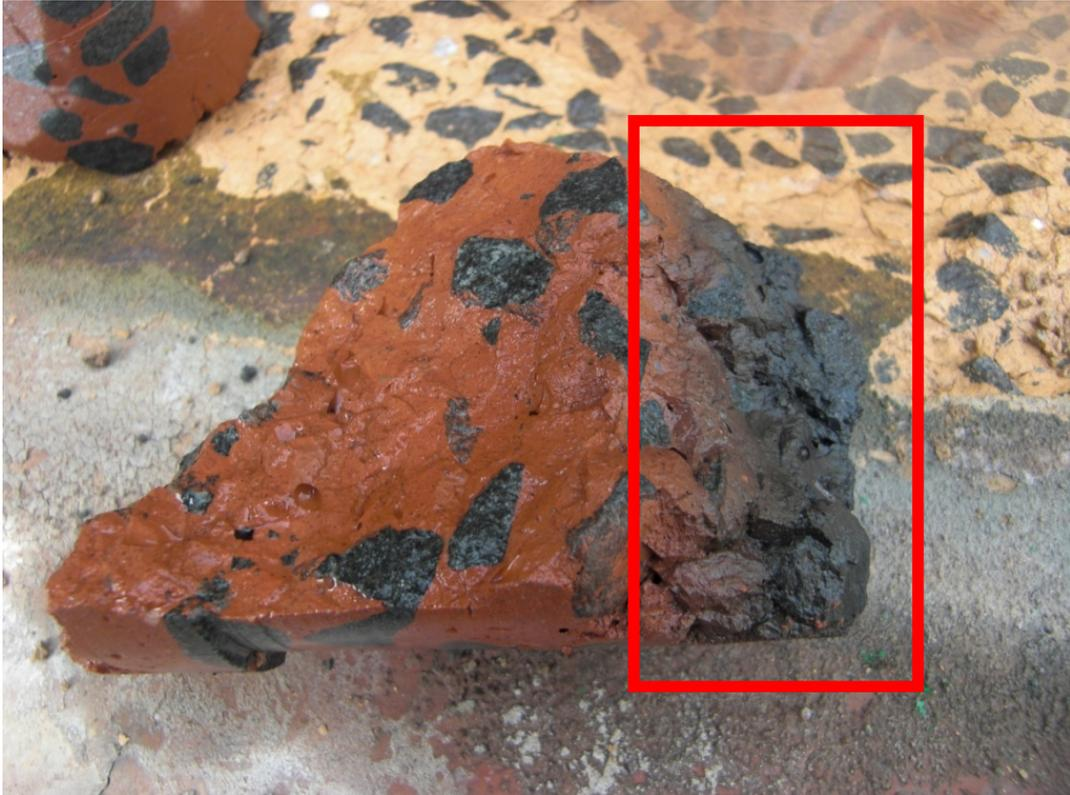
**Figura 111** – Detalhe da alteração de cor promovida pela reação química de redução do óxido de ferro ( $\text{Fe}_2\text{O}_3$ ) nos primeiros milímetros de exposição do pilar (amostra extraída na região do centro da face exposta ao fogo do elemento).
