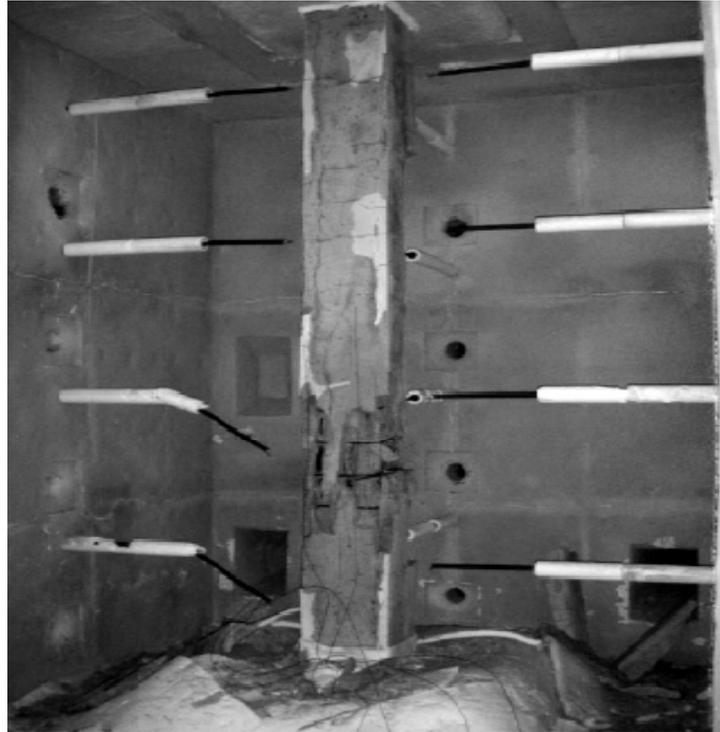
**Figura 43** – Condições do pilar 120-305 após o experimento de simulação de incêndio (Park et al., 2007, original em preto e branco).
