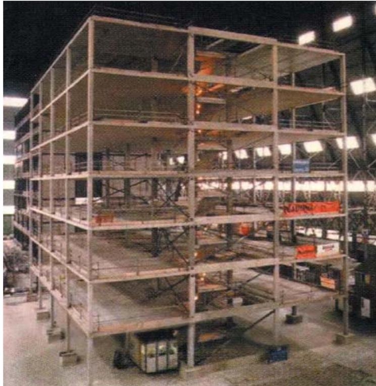
**Figura 36** – Perspectiva da estrutura de concreto armado protótipo concebida para o experimento de simulação de incêndio em *Cardington* (Chana e Price, 2003).
