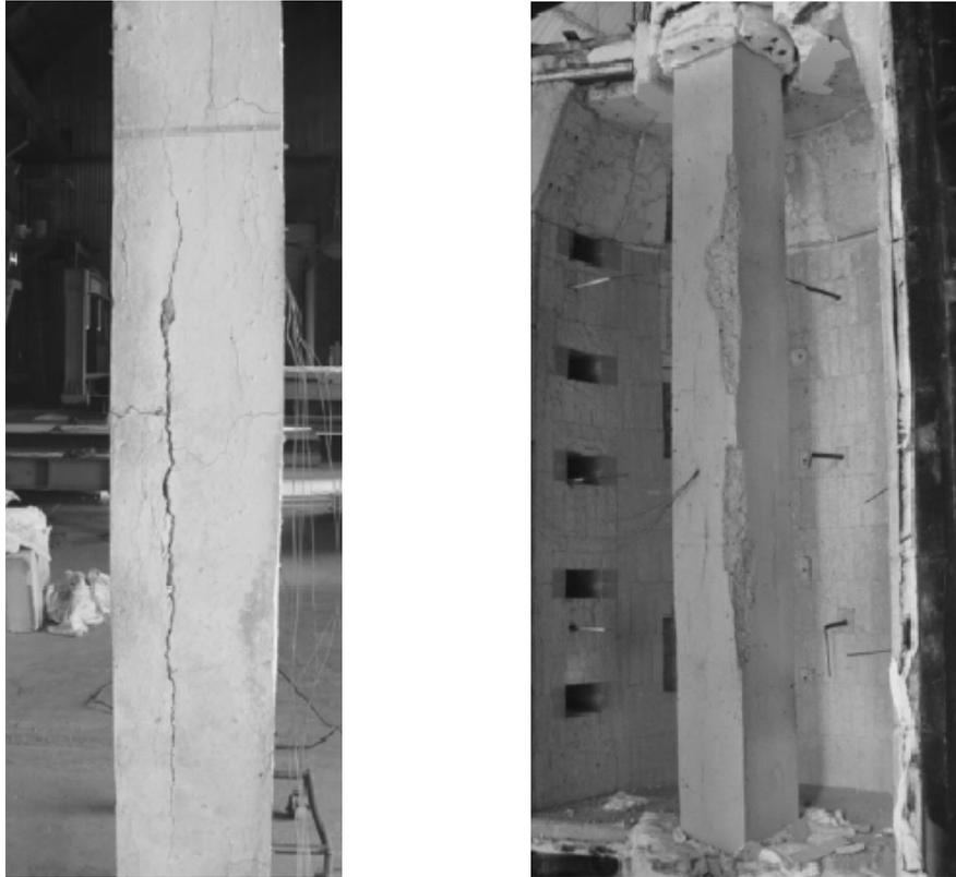
**Figura 42** – Condições do pilar de pequena dimensão 50-305c após o experimento de simulação de incêndio (Park et al., 2007, original em preto e branco).
