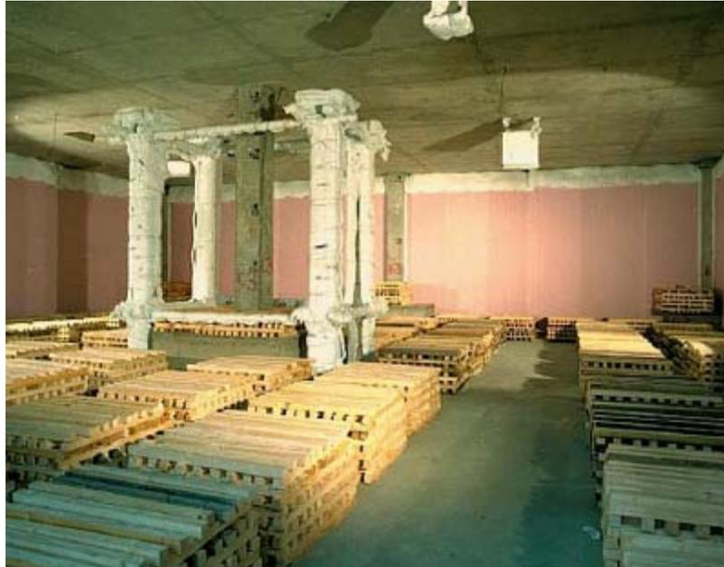
**Figura 38** – Compartimento precedente à simulação de incêndio, com os estrados de madeira posicionados. Observar quatro pilares “extras” protegidos por revestimento refratário (segurança da estrutura) e um pilar central de 103MPa, além de pilares periféricos, expostos ao fogo (Chana e Price, 2003).
