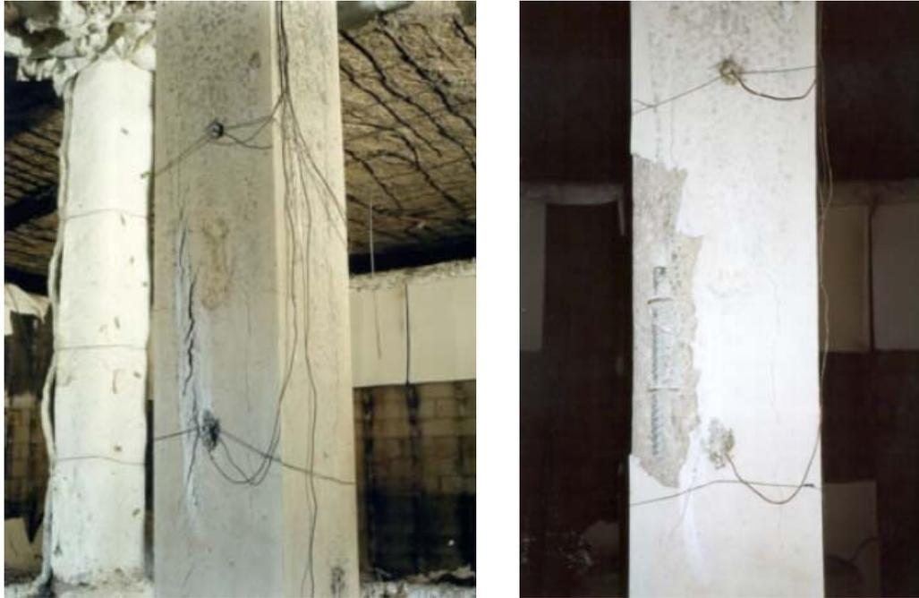
**Figura 40** – Detalhes do pilar de concreto de alta resistência após a simulação de incêndio (Chana e Price, 2003).
