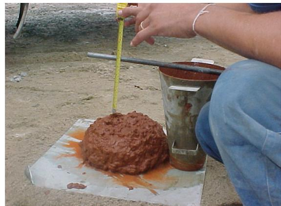
**Figura 56** – Aspecto do concreto colorido de alta resistência, sendo descarregado e ensaiado no canteiro da obra do edifício e-Tower, em 2002 (acervo do Prof. Paulo Helene).
