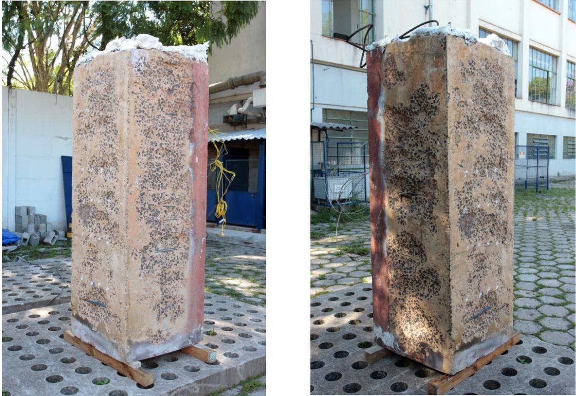
**Figura 103** – Visão geral do pilar posterior ao evento de simulação de incêndio (detalhe das faces).
