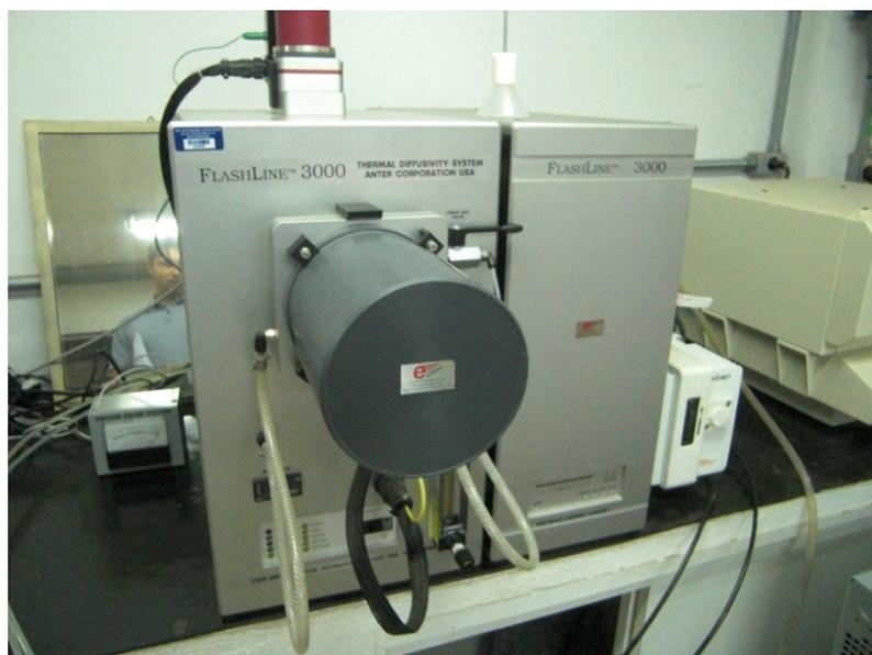
**Figura 66** – Equipamento *Thermal Diffusivity System* modelo *FlashLine™ 3000*.
