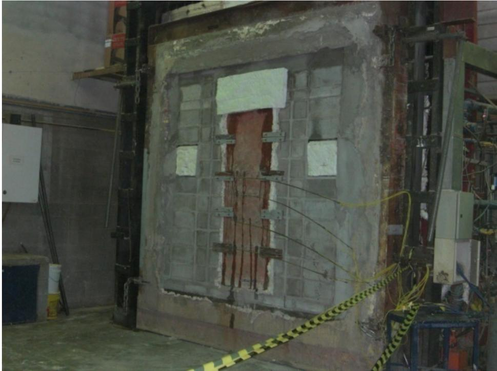
**Figura 101** – Pilar protótipo durante o experimento laboratorial de simulação de incêndio.
