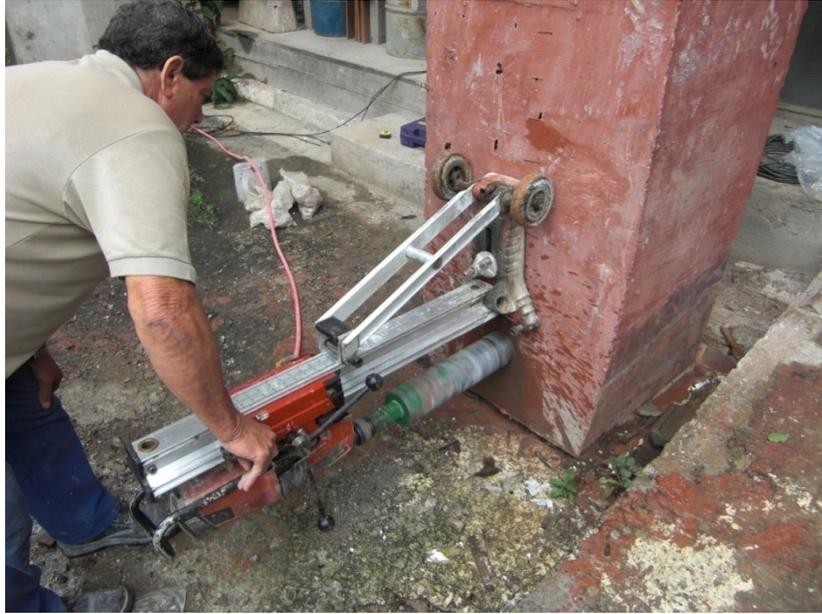
**Figura 58** – Detalhe da extração dos testemunhos na parte inferior (base) do pilar protótipo (região pertencente à futura parte remanescente).
