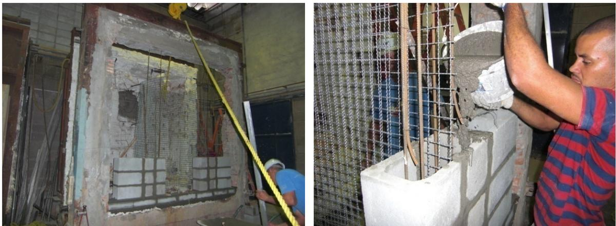
**Figura 91** – Detalhe da execução da alvenaria com grauteamento na parte vinculada à tela de aço e à amostra.
