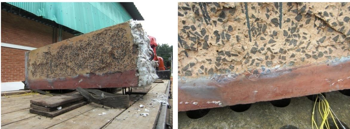
**Figura 109** – Detalhe da diferença de coloração do pilar protótipo após o experimento de simulação de incêndio, podendo-se observar a coloração original (vermelha) conservada pela proteção térmica oferecida pelo engastamento do pilar na parede de fechamento.
