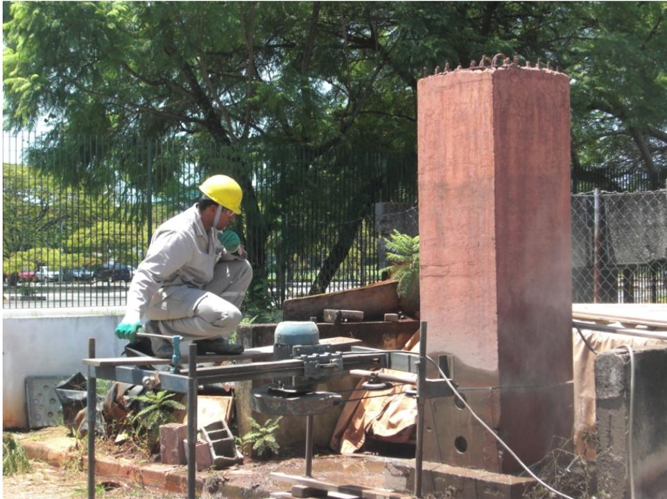
**Figura 79** – Procedimento de corte mecanizado com uso de fio diamantado do pilar protótipo no pátio do Laboratório de Concreto da Escola Politécnica da Universidade de São Paulo.
