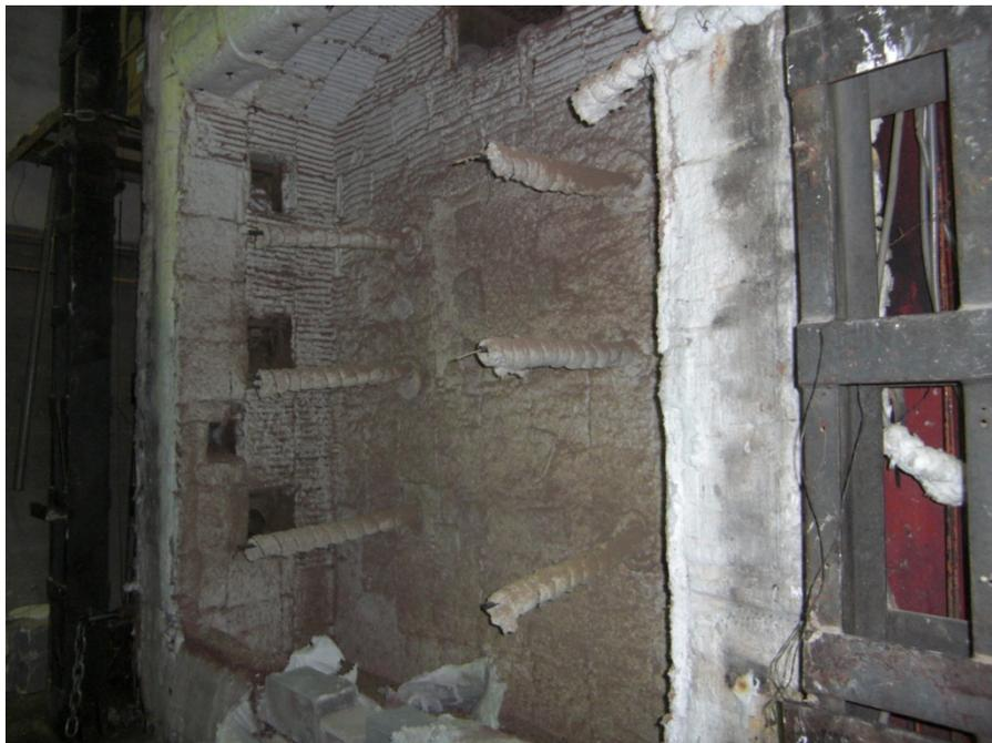
**Figura 76** – Detalhe da câmara do forno utilizado no programa experimental desenvolvido no Laboratório de Segurança ao Fogo do IPT.
