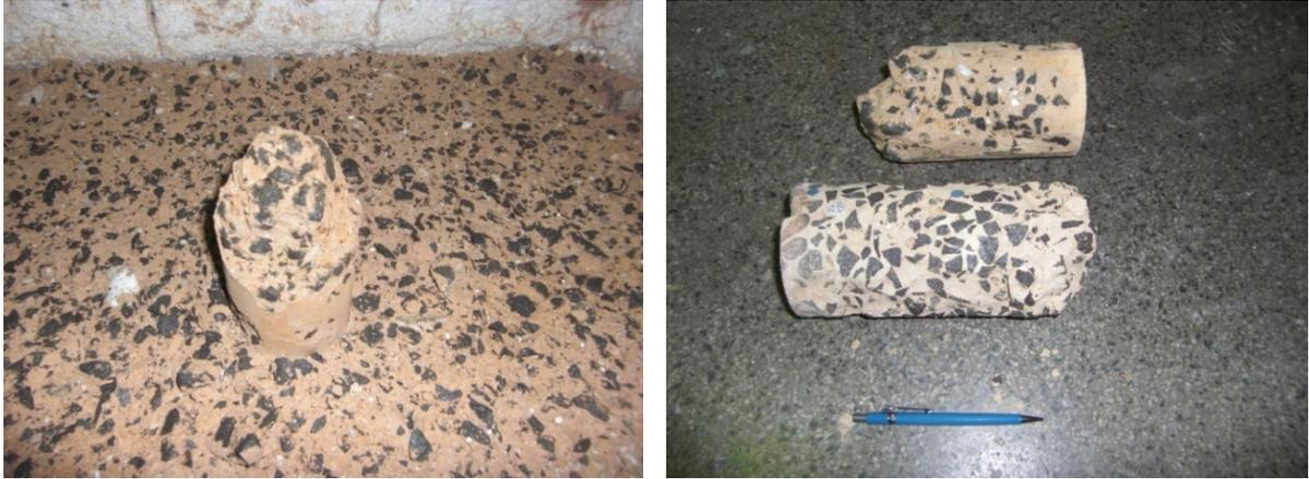
**Figura 132** – Testemunhos cilíndricos não armados com 10cm x 20cm parcialmente destruídos após exposição ao fogo, ensaiados em conjunto com o pilar protótipo, sob às mesmas condições de simulação de incêndio.
