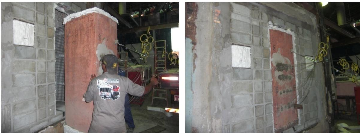
**Figura 96** – Detalhe da colocação do pilar na câmara do forno, através da alvenaria previamente construída.
