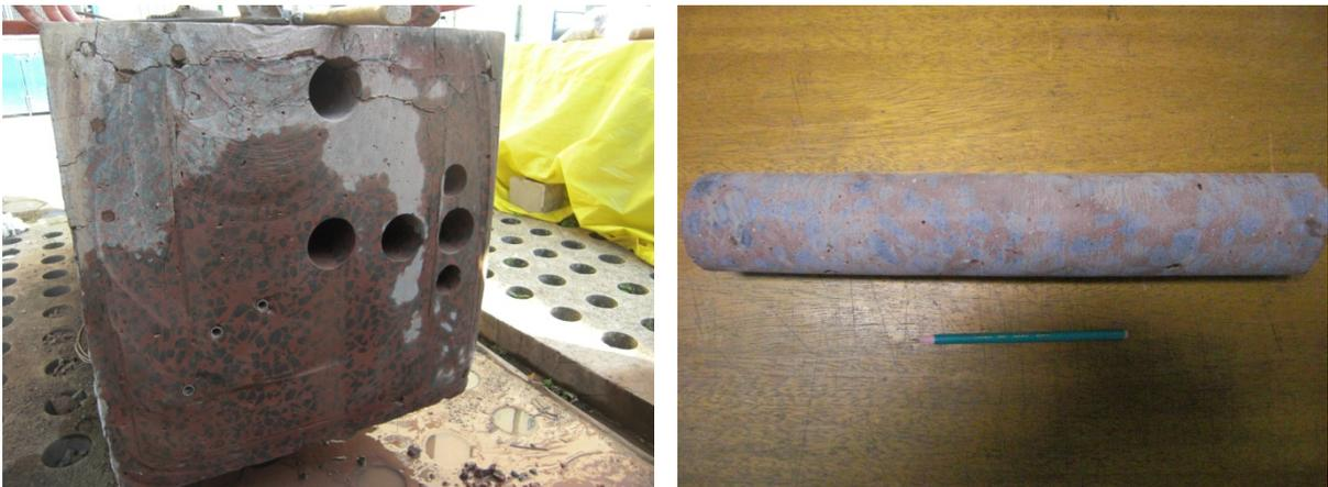
**Figura 115** – Detalhe de algumas perfurações realizadas na extremidade do pilar e detalhe de um testemunho extraído (com  $\varnothing$  75mm) para posterior ensaio ultrassom e de ruptura à compressão.
