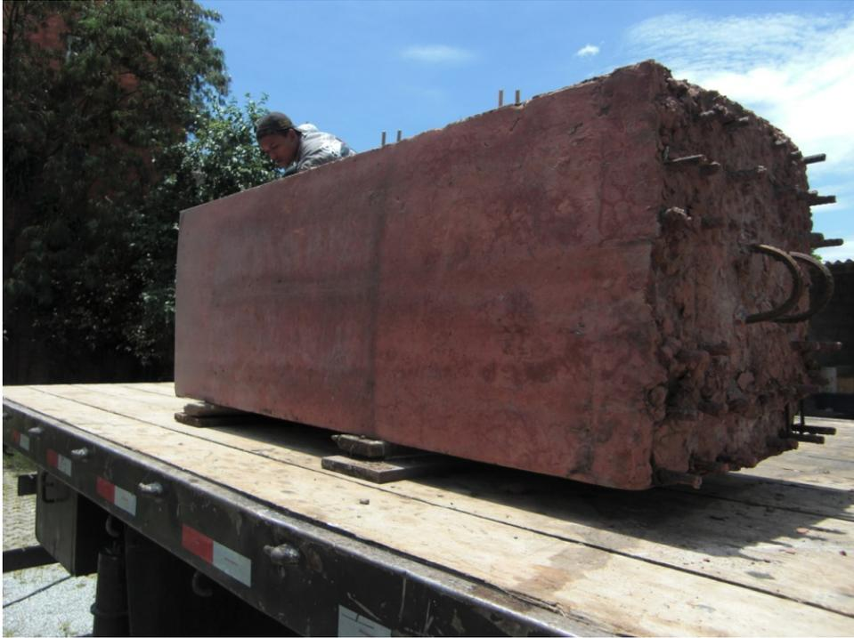
**Figura 81** – Pilar protótipo (já cortado) disposto sobre o veículo de transporte.
