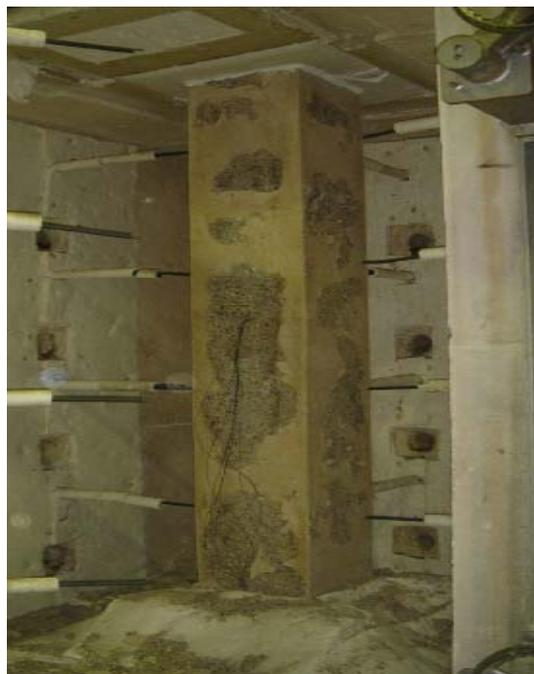
**Figura 49** – Condições do pilar com espessura de cobrimento de 70mm após o experimento de simulação de incêndio (adaptado de Park e Lee, 2008).
