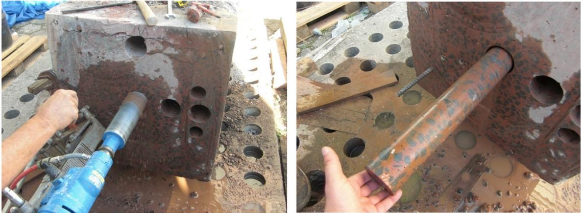
**Figura 114** – Procedimento de extração dos testemunhos na extremidade do pilar e detalhe do testemunho sendo extraído (com  $\varnothing$  75mm).
