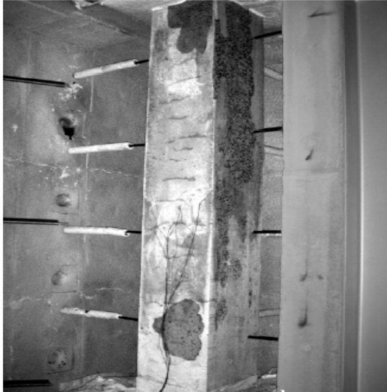
**Figura 44** – Condições excepcionais do pilar de grandes dimensões 120-500 após o experimento de simulação de incêndio por 4h (Park et al., 2007, original em preto e branco).
