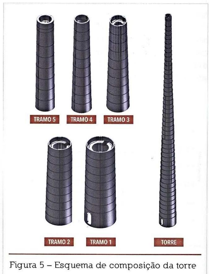
Figura 5 – Esquema de composição da torre
